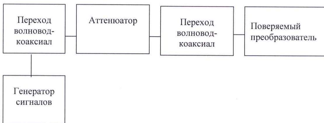
Рис. 2. Схема для определения погрешности измерения уровня мощности в динамическом диапазоне.
