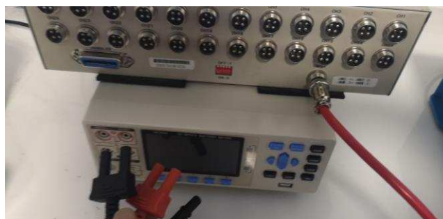
Подключение внешнего сканера ( scanning box ) к измерительному входу АКИП-6303-12 (INPUT) (при помощи соединительного кабеля).
