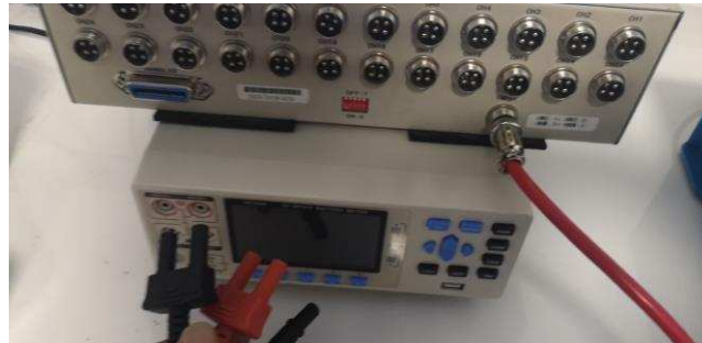
Подключение внешнего сканера ( scanning box ) к измерительному входу АКИП-6304-12 (INPUT) (при помощи соединительного кабеля).
