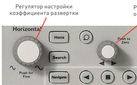
Рис. 17. Блок органов управления системой горизонтального отклонения осциллографа Keysight серии InfiniiVision 2000 X.
