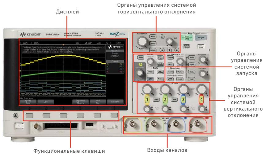
Рис. 8. Передняя панель осциллографа Keysight серии InfiniiVision 2000 X.
