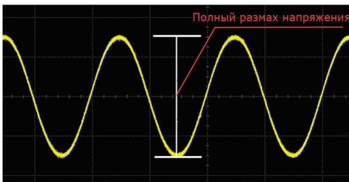
Рис. 23. Измерение амплитуды сигнала.
