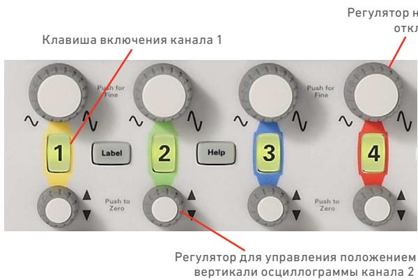
Рис. 16. Блок органов управления системой вертикального отклонения осциллографа Keysight серии InfiniiVision 2000 X.
