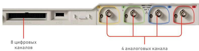
Рис. 13. Входные разъемы на передней панели осциллографа смешанных сигналов: четыре аналоговых канала и восемь или шестнадцать цифровых каналов.
