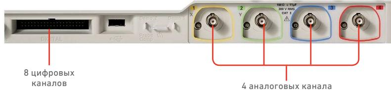
Рис. 25. Аналоговые и цифровые каналы осциллографа Keysight серии InfiniiVision 2000 X.
