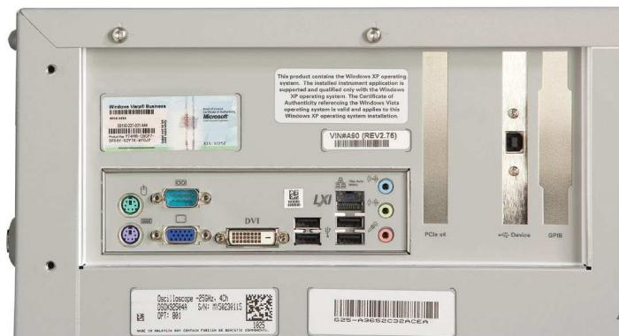
Рис. 9. Задняя панель осциллографа Keysight серии Infinium 9000.
