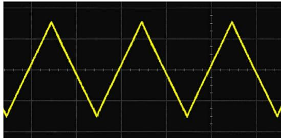
Рис. 5. Треугольный сигнал.
