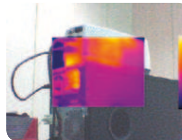
P.i.P. - Mini IR FUSION on visible picture.
