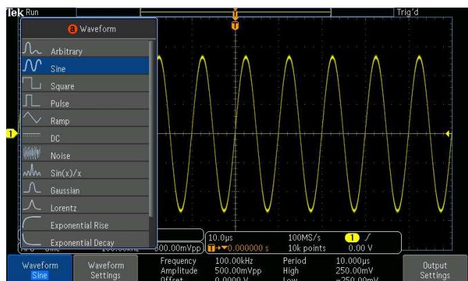
Выбор типа сигнала во встроенным генераторе сигналов произвольной формы и стандартных функций.
