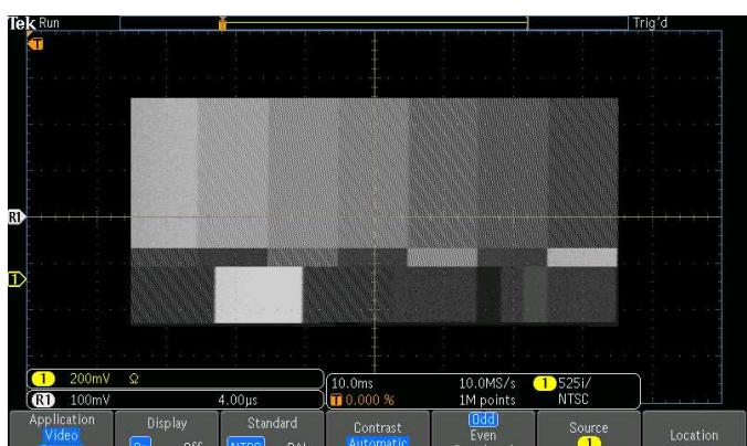
Просмотр изображения испытательной таблицы NTSC "цветные полосы". В режиме просмотра видеозображений предусмотрены автоматическая и ручная регулировка яркости и контрастности.
