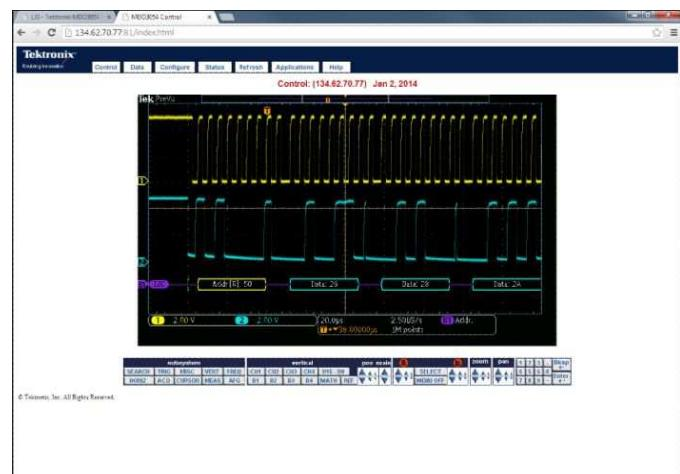
Изображение дисплея осциллографа MDO3000 отображается в обозревателе с помощью ПО e\*Scope. Это ПО можно использовать для быстрого документирования проведенных измерений в виде снимков экрана, осцилограмм или настроек, которые могут понадобиться позже.
