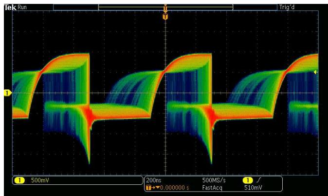
Технология цифрового люминофора с режимом захвата FastAcq поддерживает скорость захвата более 280 000 осцилограмм в секунду и отображение градаций яркости в режиме реального времени.
