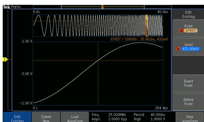
Редактор для поточечного редактирования сигналов произвольной формы
