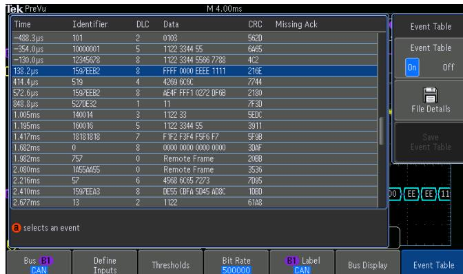
Таблица событий отображает декодированные идентификатор, код длины данных (DLC), данные и контрольную сумму (CRC) для каждого пакета шины CAN в течение длительного захвата.
