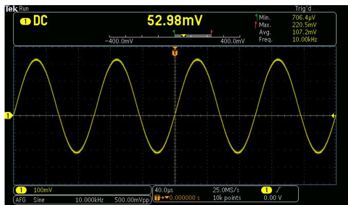
Результаты измерения в течение 5-секундного интервала представлены с указанием минимального, максимального и среднего значений постоянного напряжения. Показана также частота сигнала.
