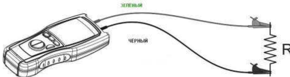
Рис.4 Схема подключения прибора для измерения сопротивления (режим « \Omega »)
