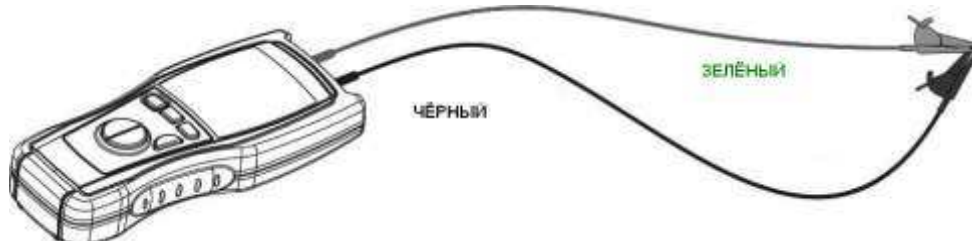
Рис.9: Схема подключения измерительных проводов для калибровки (режим «CAL»)
