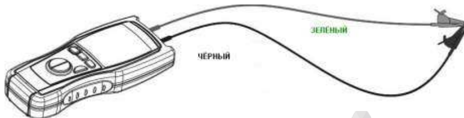
Рис.5: Схема подключения измерительных проводов прибора для калибровки.
