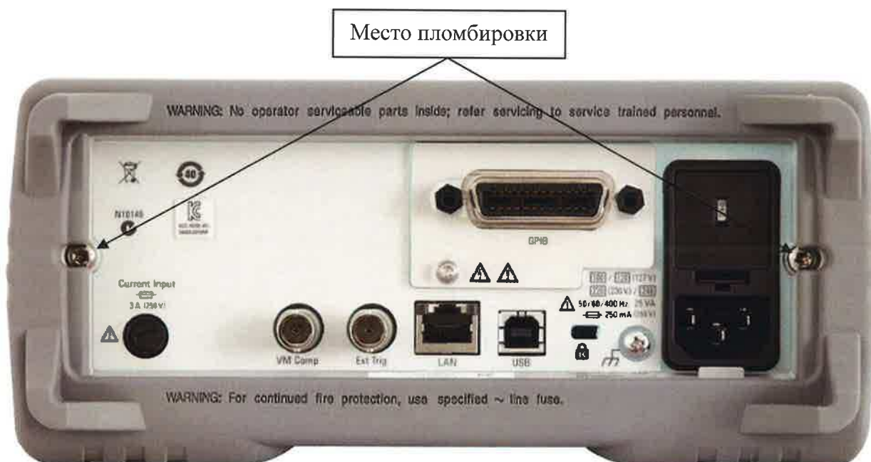
Рисунок 2 – Общий вид мультиметров цифровых 34460А. Вид сзади. Схема пломбировки от несанкционированного доступа
