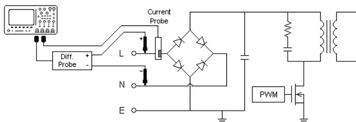
**Рис. 2** Типичная конфигурация тестов анализа входной линии
