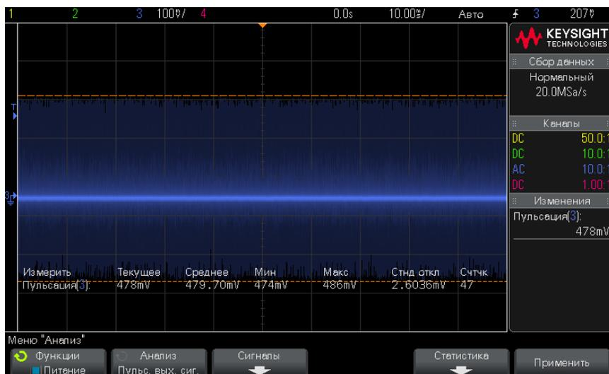
Отобразятся формы сигналов выходного напряжения со следующим автоматическим измерением мощности:
