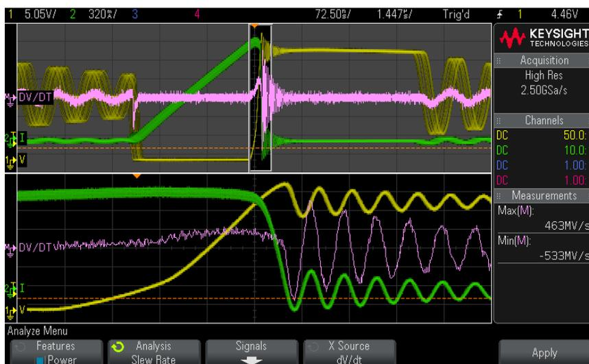
Наряду с сигналами напряжения и силы тока отобразится сигнал математической функции дифференциала, отражающий фактическую скорость нарастания.
