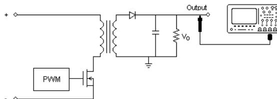
**Рис. 11** Типичная конфигурация теста пульсаций выходного напряжения
