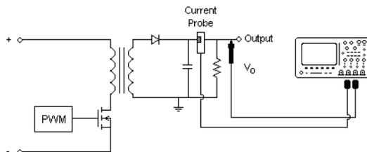
**Рис. 9** Типичная конфигурация переходной характеристики вывода питания
