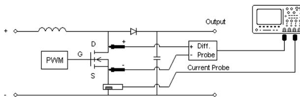
**Рис. 13** Типичная конфигурация для тестов анализа устройств питания
