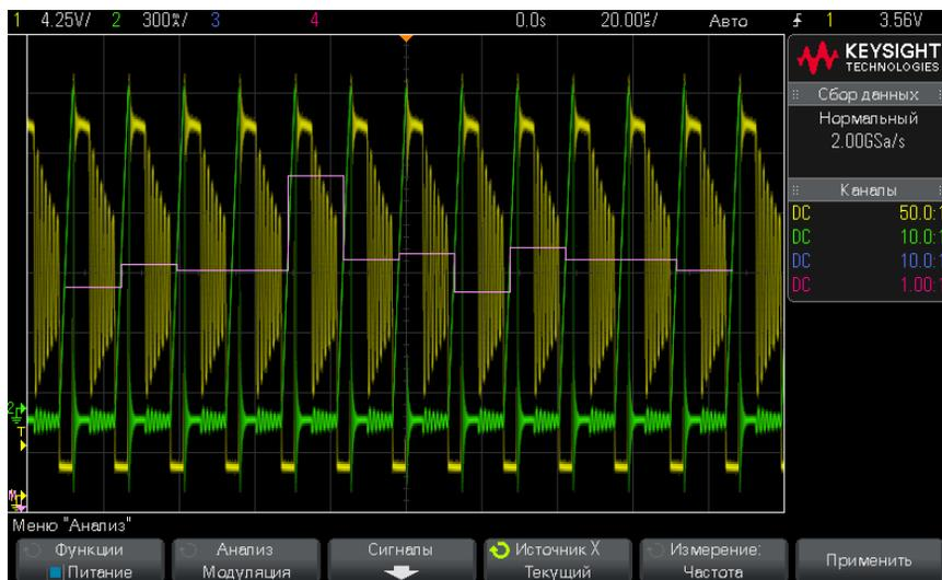
Визуализация сигнала математической функции Measurement Trend (Направление измерения) используется для построения графика изменения измерений для каждого цикла форм сигнала модуляции.
