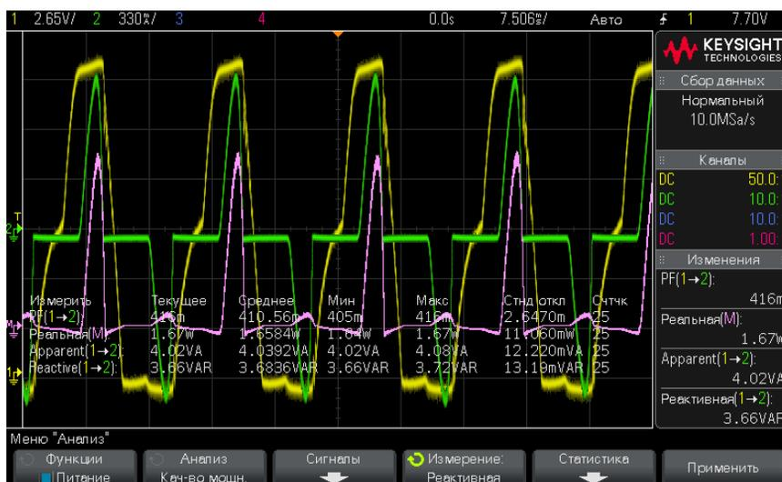
Будут отображены формы сигналов напряжения и тока, а также форма сигнала входной мощности (произведение тока и напряжения). Кроме того, будут отображены следующие выбранные и примененные измерения качества электропитания:
