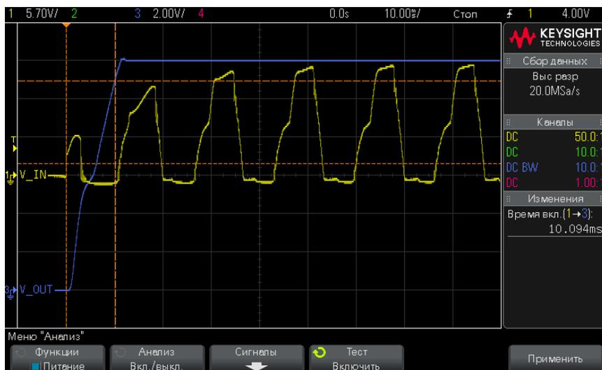
Будут отображены формы сигналов входного и выходного напряжения. Кроме того, будут отображены следующие автоматические измерения мощности:
