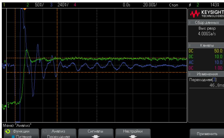
Будут отображены формы сигналов напряжения и тока. Область измерений выделена метками начала и конца периода времени. Кроме того, будут отображены следующие автоматические измерения мощности:
