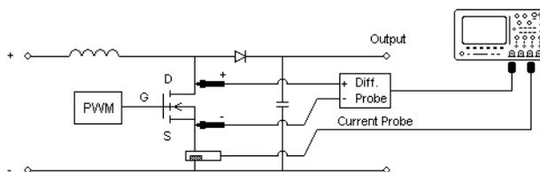
**Рис. 8** Типичная конфигурация тестов анализа силового прибора
