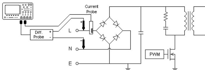
**Рис. 6** Типичная конфигурация тестов анализа входной линии
