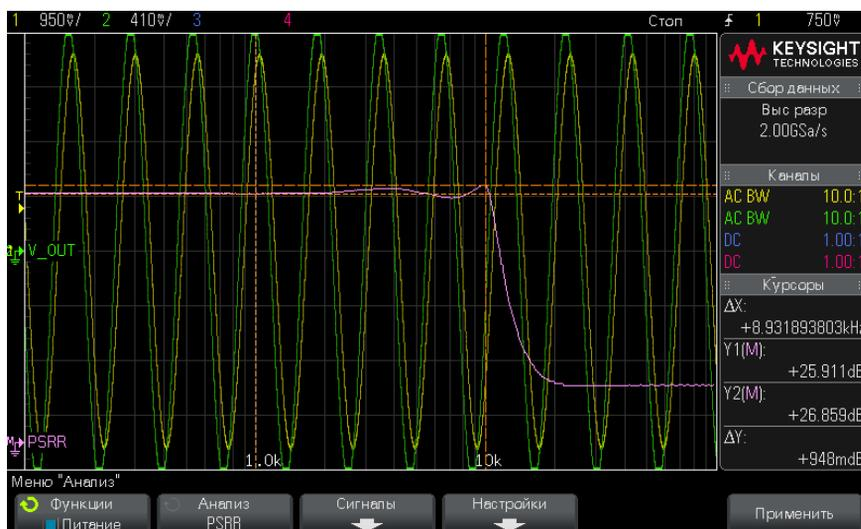
Будут отображены формы сигналов входного и выходного напряжения, а также форма сигнала математической функции PSRR. Будут также отображены отслеживаемые координаты X и Y курсора для показа значений коэффициента в дБ на разных частотах.
