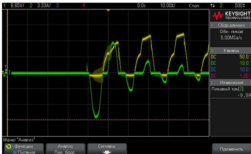
Будут отображены формы сигналов напряжения и тока. Кроме того, будут отображены следующие автоматические измерения мощности:
