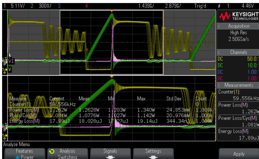
Будут отображены формы сигналов напряжения и тока, а также форма сигнала мощности (произведение тока и напряжения). Кроме того, будут отображены следующие автоматические измерения мощности и статистические данные.
