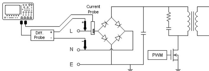
**Рис. 4** Типичная конфигурация тестов анализа пускового тока
