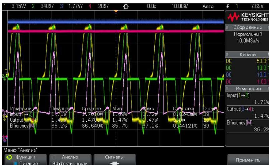
Будут отображены формы сигналов входного напряжения, выходного напряжения, входного тока, выходного тока, а также сигнал входной мощности (произведение входного тока и входного напряжения). Кроме того, будут отображены следующие автоматические измерения мощности и статистические данные.
