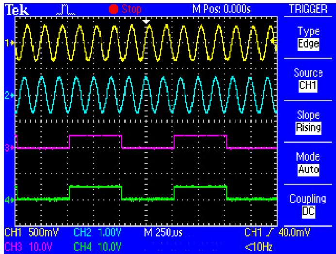
Четыре входа, выполненные по технологии IsolatedChannel™, и вход внешнего запуска позволяют быстро, точно и недорого выполнять измерения с гальванической развязкой от земли и измерения дифференциальных сигналов.
