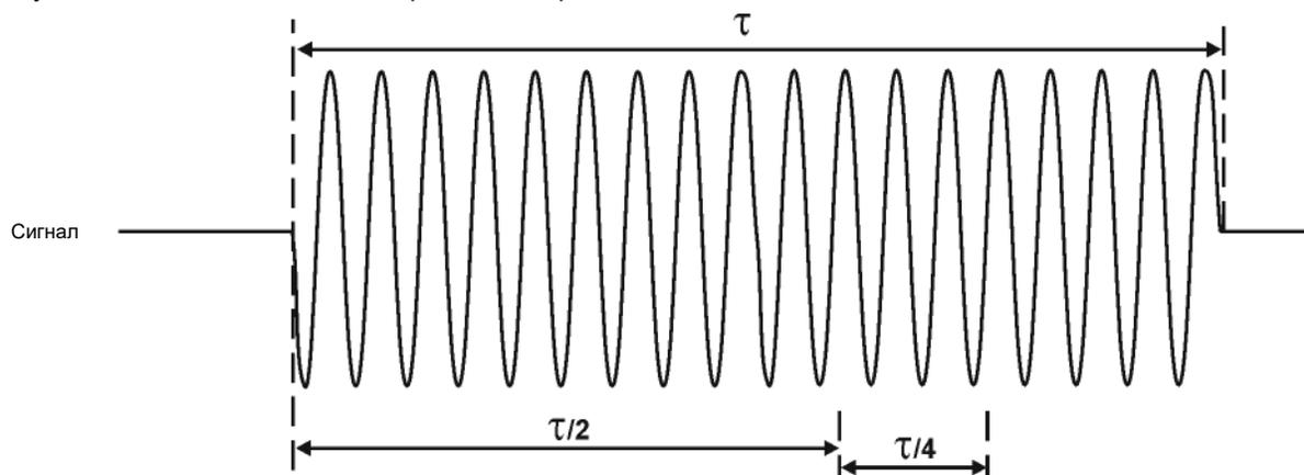
Строб можно располагать в разных позициях, но некоторые из них позволяют более гибко выбирать полосы пропускания фильтра ПЧ. Для первой попытки мы рекомендуем установить строб в промежутке от 20 до 90 % от ширины импульса. Это достаточно универсальный компромисс между установочным временем и длительностью стробирования.
