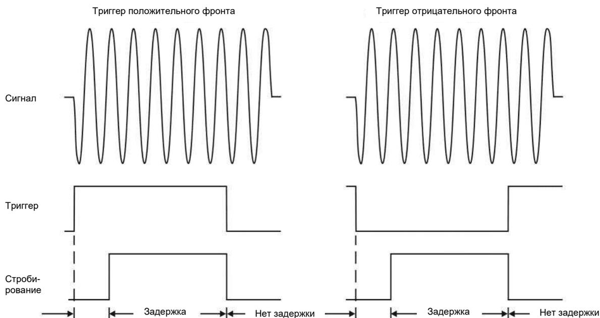
В анализаторах сигналов Keysight используются три различных реализации временного стробирования: стробирование по гетеродину, стробирование по видеотракту, стробирование по БПФ.
