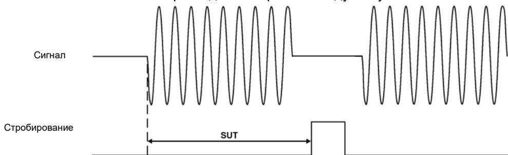
**Шаг 5.** Полоса разрешения должна быть настроена для стробирования по гетеродину и стробирования по видеотракту. Полоса видеочастотного фильтра должна настраиваться только для стробирования по видеотракту.
