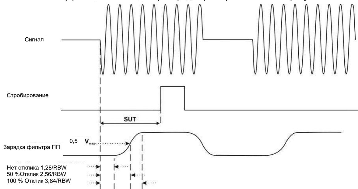
Фильтры ПЧ представляют собой устройства, ограниченные по полосе, поэтому им нужно некоторое конечное время, чтобы отреагировать на смену условий. А именно, фильтрам нужно время на полную зарядку после того, как анализатор обрабатывает импульсный сигнал.
