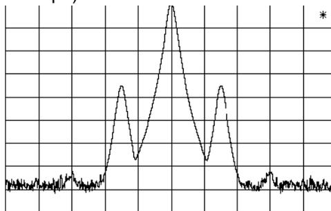
Перемещая строб так, чтобы он приходился на середину сигнала 2, вы получите результат, представленный на [рисунке 12-15](#). Здесь отображается спектр только для импульсов сигнала 2, а сигнал 1 полностью исключается.
