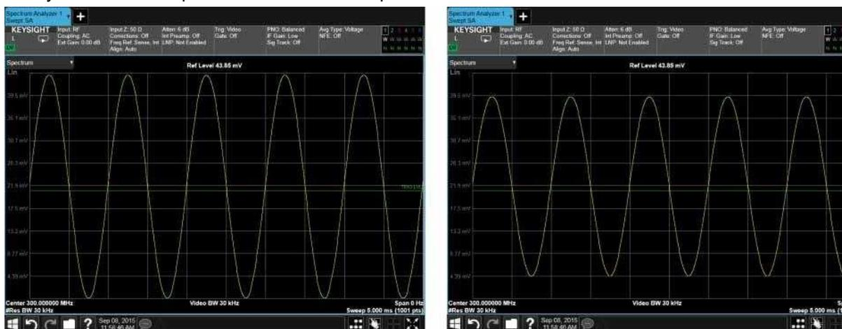
СЛЕВА: 100 % АМ сигнала (коэффициент модуляции = 1)
