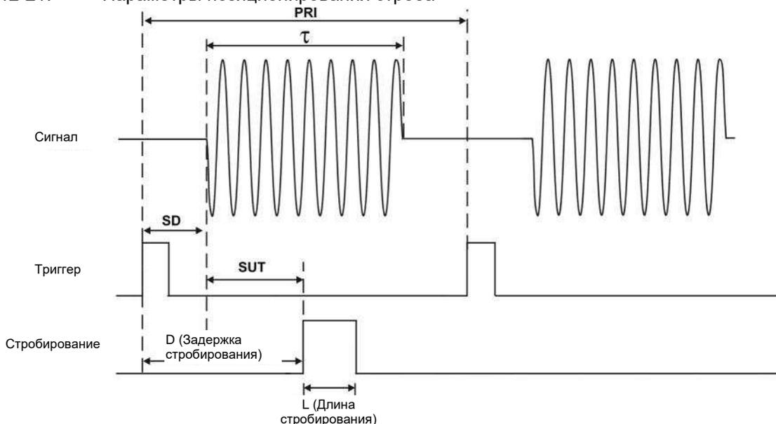
Почти все параметры управления определяются двумя основными параметрами изучаемого сигнала: интервал повторения импульсов и длительность импульса ( $\tau$ ). Если вы знаете эти параметры, вы можете для начала выбрать стандартные настройки. Таблица 12-2 описывает параметры сигнала, для которого событие триггера формируется одновременно с началом импульса (то есть SD имеет значение 0). Если для вашего сигнала задержка имеет ненулевое значение, добавьте необходимую задержку стробирования.
