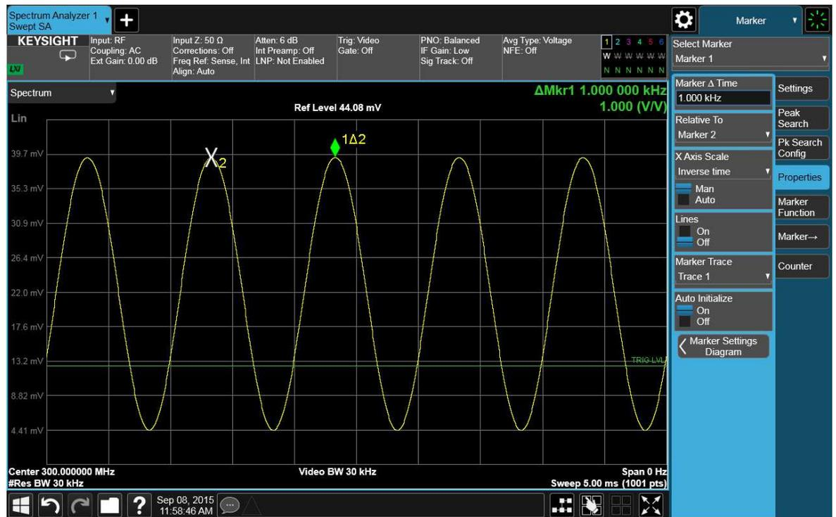
Еще одним способом вычисления глубины модуляции может быть просмотр сигнала в частотной области и измерения дельта-частоты между пиковым значением несущей и первой боковой полосой. См. Рисунок 10-5.
