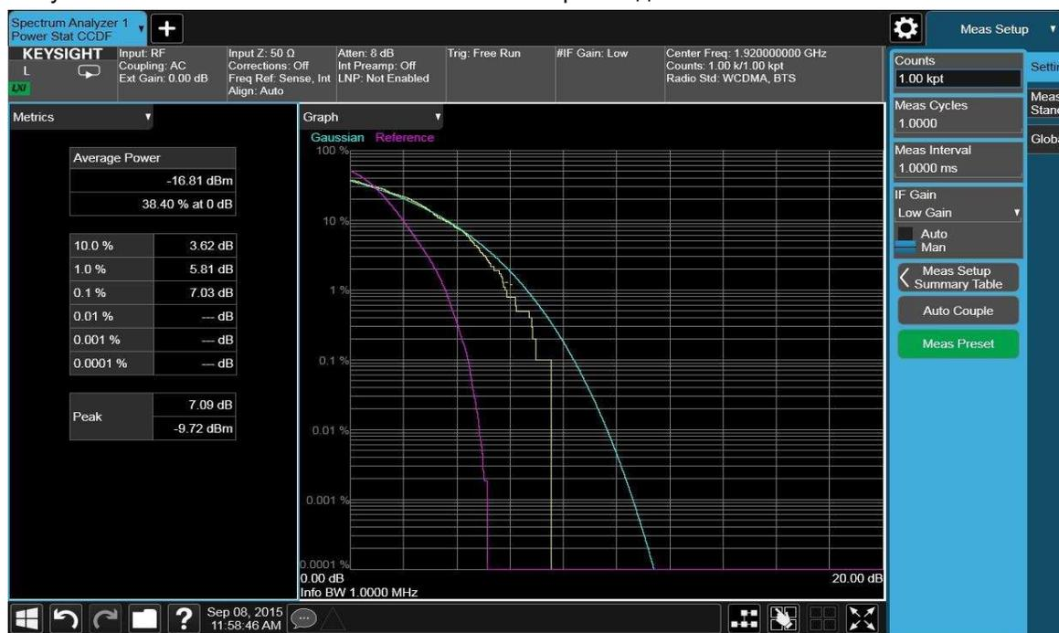
**ПРИМЕЧАНИЕ** Количество отсчетов измерения за развертку, зависит от частоты дискретизации и интервала измерений. Количество обработанных выборок отображается вверху экрана. График постоянно обновляется, так что вы наглядно видите, как он сглаживается по мере снижения погрешности измерений и увеличения повторяемости.
