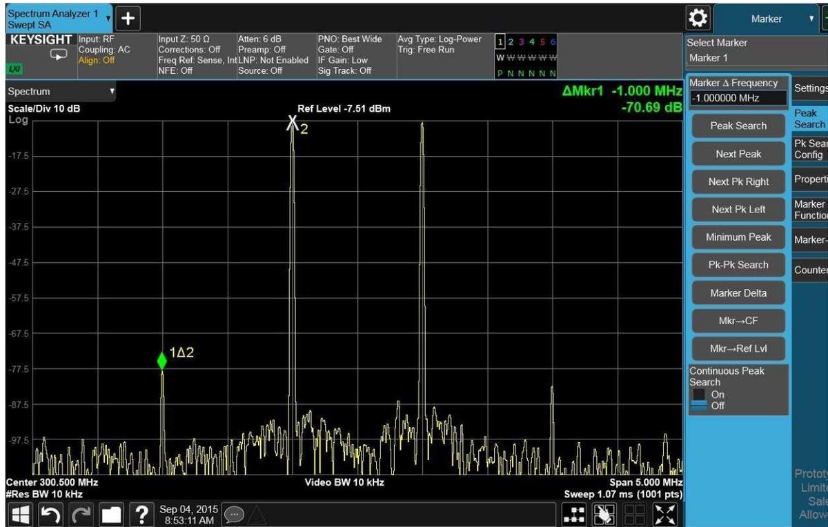
Рисунок 6-6. Измерения искажений — второй сигнал и его искажение
