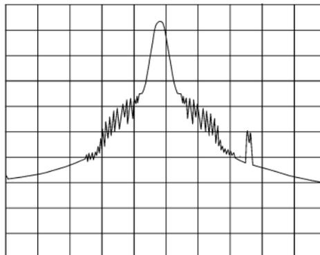
Рисунок 12-6. Спектр стробированного по времени сигнала «Радио 2»
