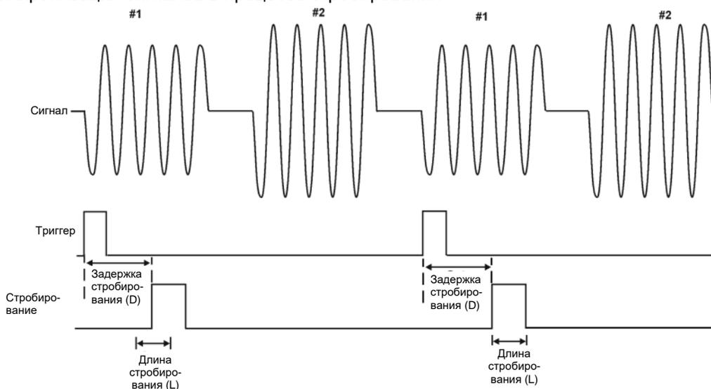
Когда анализатор сигналов будет настроен для измерений в режиме стробирования, отображается только спектр сигнала 1, а спектр сигнала 2 исключается, как показано на [рисунке 12-13](#). Кроме того, при просмотре сигнала 1 вы удаляете еще и спектр, приходящийся на фронты импульса. Таким образом, стробирование позволяет просматривать такие компоненты спектра, которые в других режимах будут скрыты.
