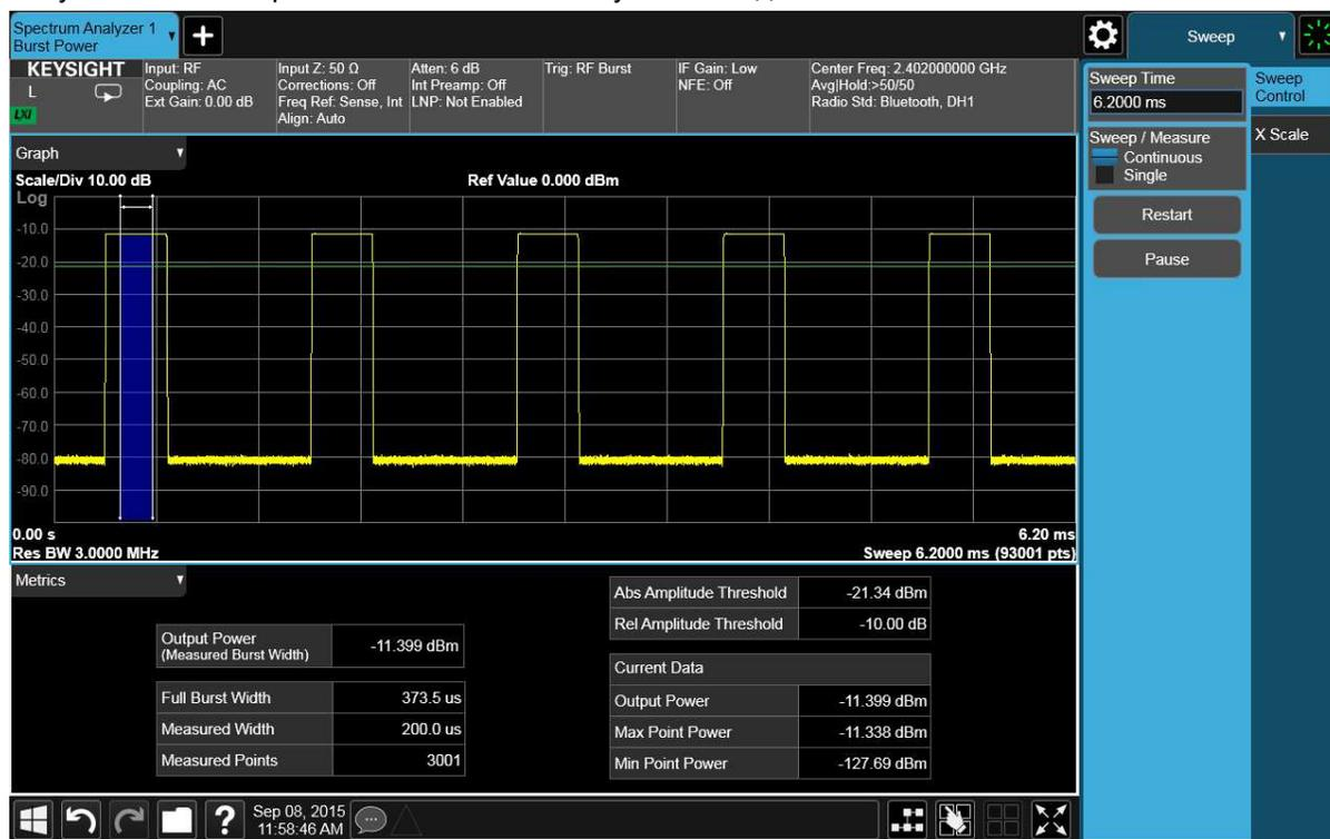
**ПРИМЕЧАНИЕ** Хотя мощность импульса измеряется правильно даже при наличии на дисплее нескольких импульсов одновременно, временная точность измерения при этом снижается. Рекомендуется проводить измерения на отдельно взятом импульсе, чтобы обеспечить наилучшие результаты (включая оптимальное соотношение вариативности измерений и времени усреднения).
