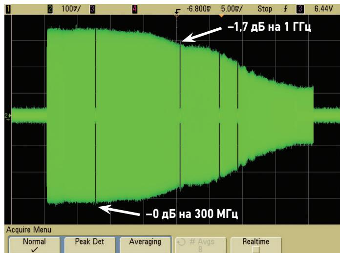
Рис. 7. АЧХ осциллографа Keysight MS07104B с полосой пропускания 1 ГГц
