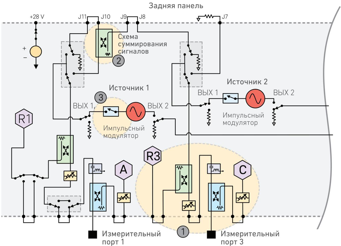
4. Переключаемые перемычки задней панели обеспечивают возможность добавления оборудования формирования сигналов или подключения дополнительного измерительного оборудования к тестируемому устройству (ТУ) без переподключения измерительных кабелей.
