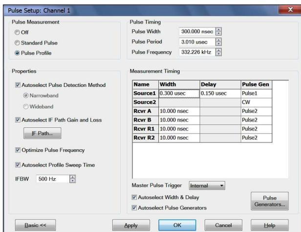
Приложение для измерений параметров импульсных ВЧ-сигналов автоматически оптимизирует конфигурацию внутренних аппаратных средств для конкретных условий формирования импульсов, значительно упрощая установку параметров испытаний. В качестве альтернативы, пользователи могут выбрать ручную установку аппаратных средств для удовлетворения уникальных требований испытаний.
