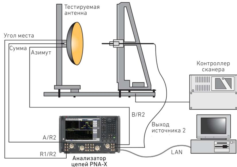
PNA-X, сконфигурированный для измерений параметров антенн в ближнем поле.
