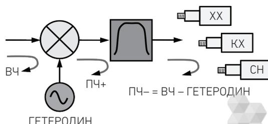
Патентованный метод векторной калибровки смесителей/ преобразователей частоты (VMC) компании Keysight использует меры холостого хода (XX), короткого замыкания (KЗ) и согласованной нагрузки (СН) для определения характеристик калибровочного смесителя.
