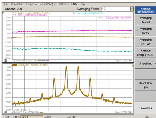
Спектр интермодуляционных искажений (IM Spectrum) в нижнем окне отображает спектр, соответствующий положению маркера в центре графика измерения интермодуляционных искажений в режиме свипирования (в верхнем окне). Для уменьшения девиации шума к спектру IM Spectrum применяется усреднение по точкам.
