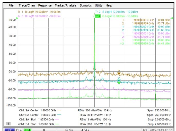
На верхнем графике показано измерение паразитного сигнала с уровнем -84 дБм в присутствии сигнала с уровнем +10 дБм. Отношение сигнал/шум (сверху вниз) приблизительно равно (при полосе пропускания): 80 дБ (300 кГц), 90 дБ (30 кГц), 100 дБ (3 кГц) и 110 дБ (300 Гц)
