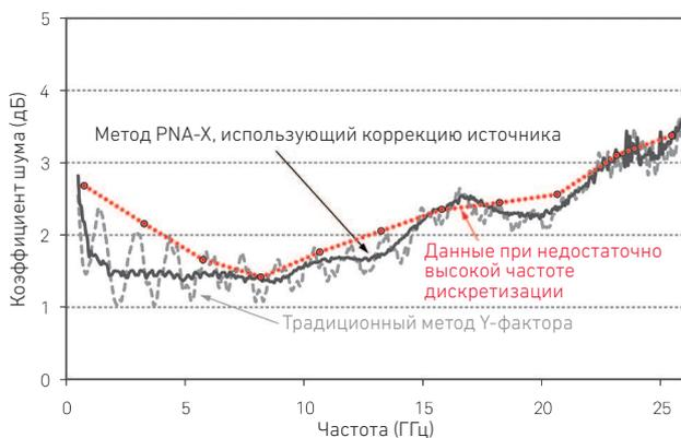
При использовании 401 точки измерения характеристик несогласованного транзистора PNA-X показывает намного меньший уровень неравномерности характеристики по сравнению с методом Y-фактора. 11 точек измерения, получаемые по умолчанию с помощью анализатора коэффициента шума серии NFA недостаточны, что приводит к ложным результатам измерения характеристик усилителя.
