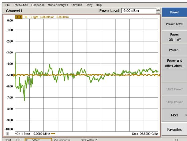
Использование функции выравнивания уровня по приёмнику уменьшает погрешность измерения уровня мощности импульсного ВЧ-сигнала с ±1 дБ до менее чем 0,05 дБ.
