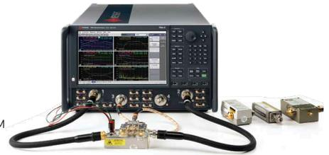
Класс скалярных измерений смесителей/ преобразователей частоты плюс фазы (SMC+Phase) приложения S93083A упрощает установку измерений смесителей и преобразователей частоты, так как опорный и калибровочный смеситель не требуются. Калибровка легко выполняется с использованием трёх широкополосных мер: измерителя мощности в качестве меры уровня мощности, генератора комбинационных частот в качестве меры фазы и калибровочного комплекта S-параметров (механического или модуля ECal).
