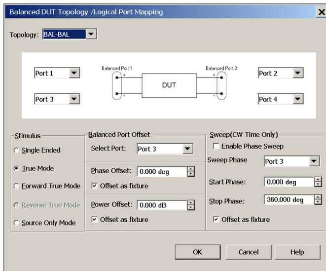
В диалоговом окне Balanced DUT Topology (топология балансного тестируемого устройства) доступны различные установки испытательных сигналов и режимов свипирования, которые позволяют правильно настроить параметры прибора для измерения характеристик тестируемых устройств (ТУ).
