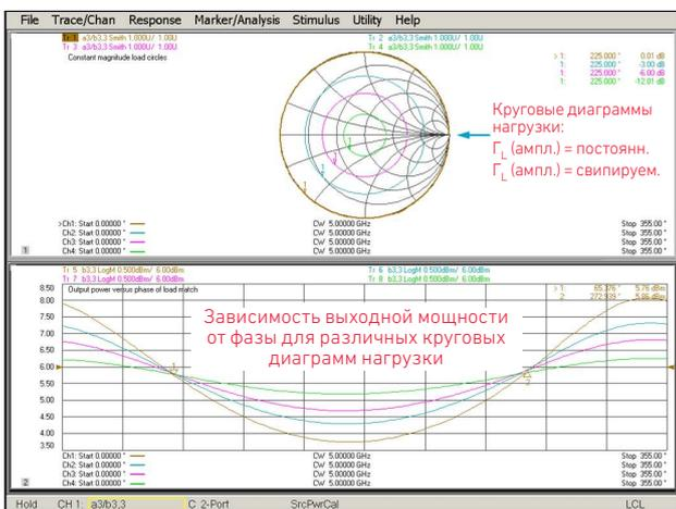
Пример круговых диаграмм нагрузки, сгенерированных посредством поддержания амплитуды импеданса нагрузки  $\Gamma_L$  постоянной в процессе свипирования фазы.
