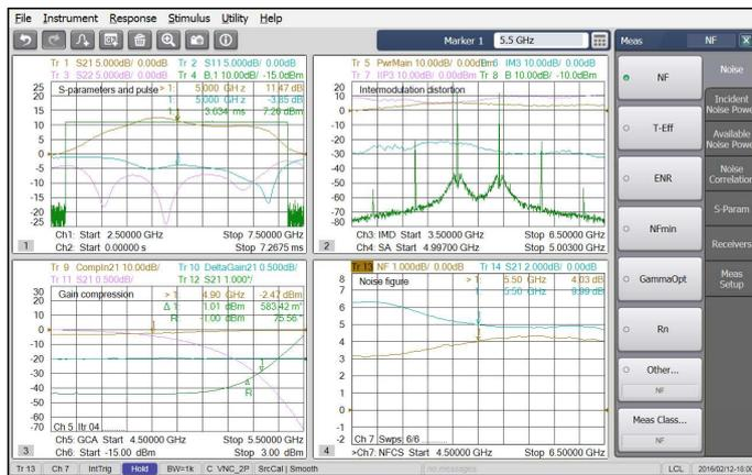
Используя один набор подключений к усилителю или преобразователю частоты, PNA-X может измерять S-параметры, интермодуляционные искажения, зависимость компрессии коэффициента усиления и фазы от частоты, коэффициент шума и многое другое в режиме НГ (непрерывная генерация гармонических сигналов) и импульсных режимах.
