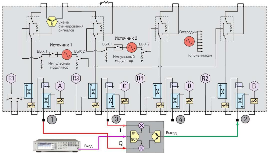
Сигналы на I/Q-входы модулятора можно подавать непосредственно с выходов внутренних источников сигналов PNA-X, исключая тем самым необходимость в использовании гибридных ответвителей со сдвигом фаз между выходными каналами  $90^\circ$ .
