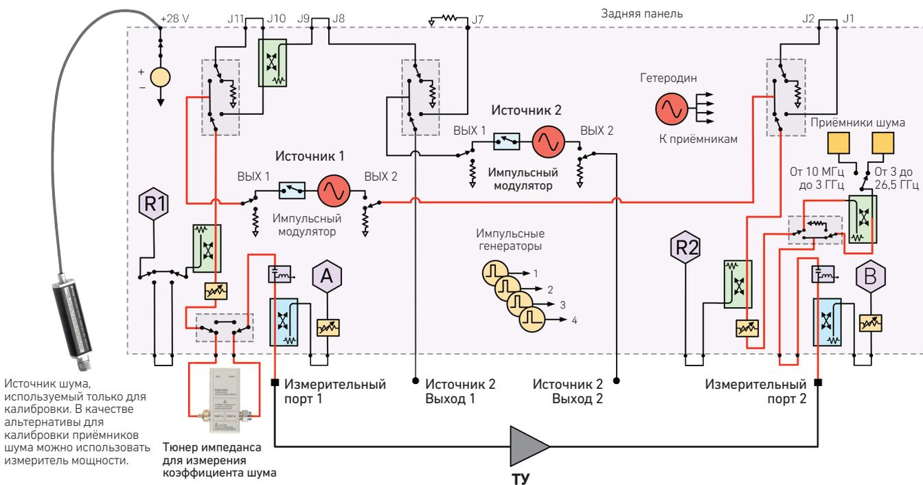
Источник шума, используемый только для калибровки. В качестве альтернативы для калибровки приёмников шума можно использовать измеритель мощности.
