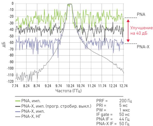
Метод узкополосного детектирования PNA-X, используемый при коротких длительностях импульса (< 267 нс) использует специальные аппаратные средства и патентованные методы программного стробирования для улучшения динамического диапазона системы при измерениях с низким коэффициентом заполнения импульсов на 40 дБ по сравнению с системами, измеряющими параметры импульсных ВЧ-сигналов, на базе PNA.
