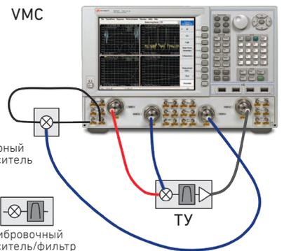
Метод векторной калибровки смесителя (VMC) обеспечивает измерения согласования по входу и выходу, потерь/усиления преобразования, абсолютного ГВЗ, разности фаз между несколькими трактами или устройствами и фазовых сдвигов внутри устройства.
