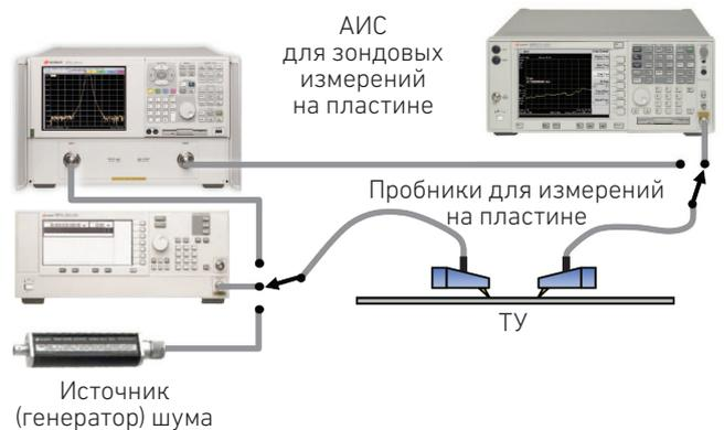
При измерениях с использованием метода Y-фактора любая электрическая цепь, подключенная между источником шума и ТУ (кабели, коммутационные матрицы, пробники для измерений на пластине), приводит к значительному ухудшению точности измерений.
