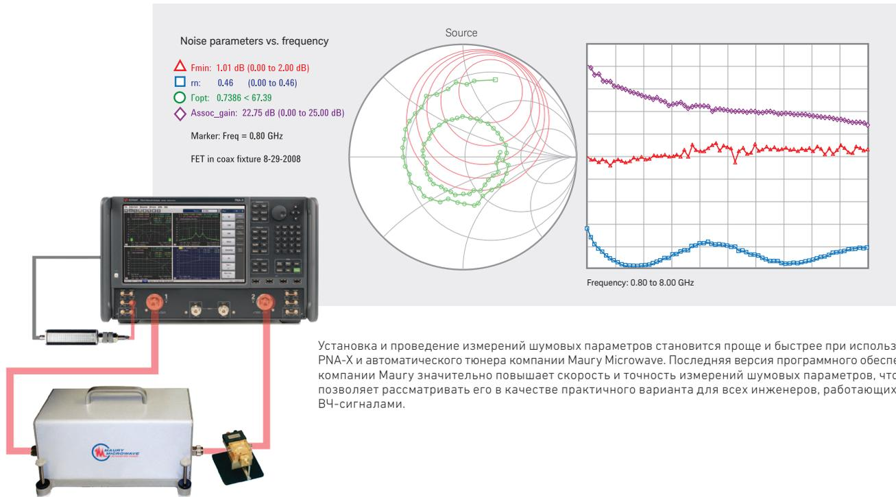
Установка и проведение измерений шумовых параметров становится проще и быстрее при использовании PNA-X и автоматического тюнера компании Maury Microwave. Последняя версия программного обеспечения компании Maury значительно повышает скорость и точность измерений шумовых параметров, что позволяет рассматривать его в качестве практического варианта для всех инженеров, работающих с ВЧ-сигналами.
