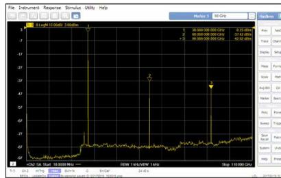
Приложение анализатора спектра PNA используется для измерения гармоник усилителя мм-диапазона.
