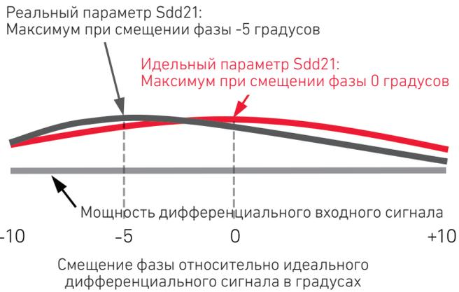
Измерение ТУ со свипированием смещения фазы в тестовой оснастке позволяет выявить оптимальное значение смещения фазы для достижения наивысшего коэффициента усиления, что крайне необходимо при разработке входной схемы согласования.
