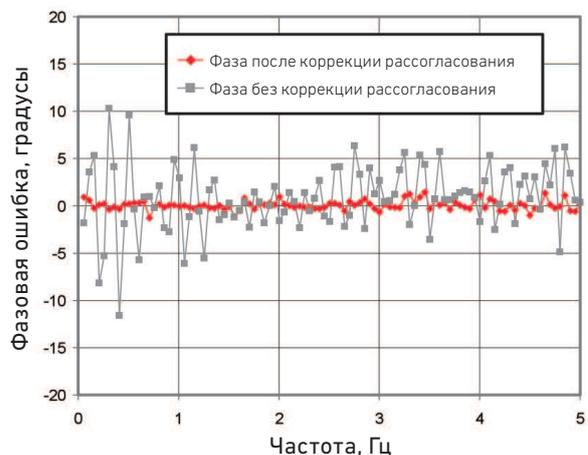
Приложение iTMSA компенсирует ошибки рассогласования путём предварительного измерения согласования ВАЦ и ТУ и последующей точной настройки амплитуды и фазы двух сигналов в опорной плоскости для получения идеальных истинных испытательных сигналов.
