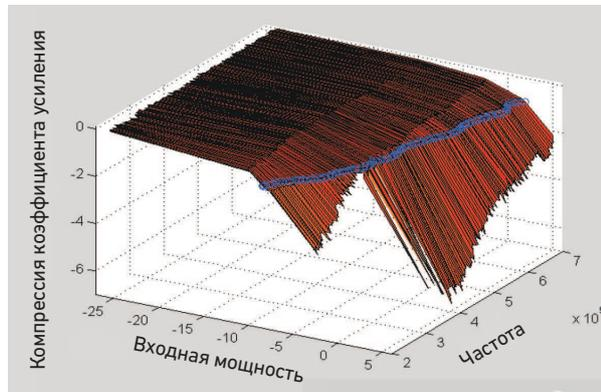
Исходные измеренные данные при интеллектуальном (SMART) свипировании, когда безопасный режим (Safe Mode) выключен (вверху) и включён (внизу). В последнем случае используется больше итераций, поскольку коэффициент усиления теснее приближается к точке компрессии на 1 дБ при включённом безопасном режиме, который минимизирует избыточную мощность возбуждения.
