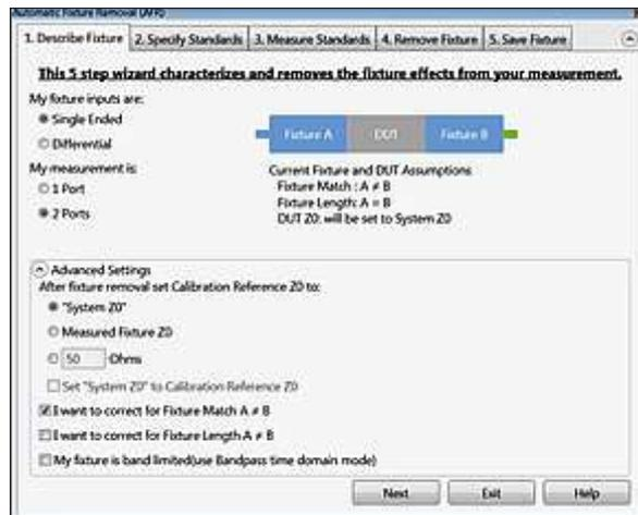
Мастер приложения, включающий пять шагов, руководит действиями пользователя в процессе определения параметров тестовой оснастки и удаления их из результатов измерения.
