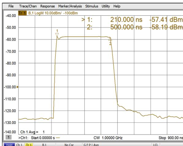
Измерение профиля импульса при использовании метода узкополосного детектирования даёт 30 точек измерения в пределах длительности импульса 300 нс, обеспечивая временное разрешение 10 нс.
