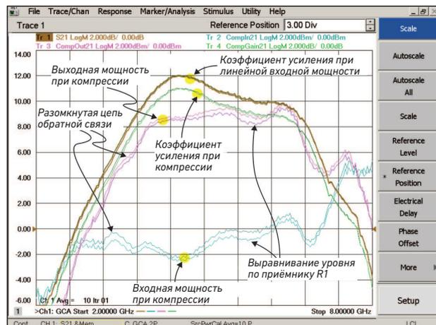
Выше показано сравнение результатов измерений с выравниванием уровня по приёмнику и без него при измерениях компрессии коэффициента усиления. Неточное определение уровней испытательных сигналов приводит к большим погрешностям при измерениях, связанных с определением уровня мощности, таких как определение зависимости уровня входной и выходной мощности в точке компрессии от частоты.
