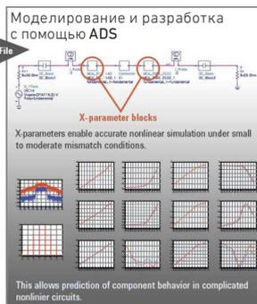
Измерение полных характеристик линейного и нелинейного поведения компонентов с помощью NVNA, затем точное проведение моделирования и оптимизации с помощью САПР Advanced Design System (ADS) компании Keysight.
