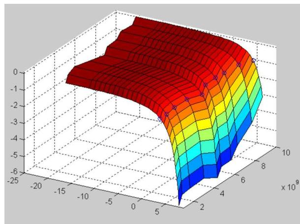
Полное определение характеристик устройства с помощью двумерного свипирования: зависимость коэффициента усиления от частоты и уровня мощности.
