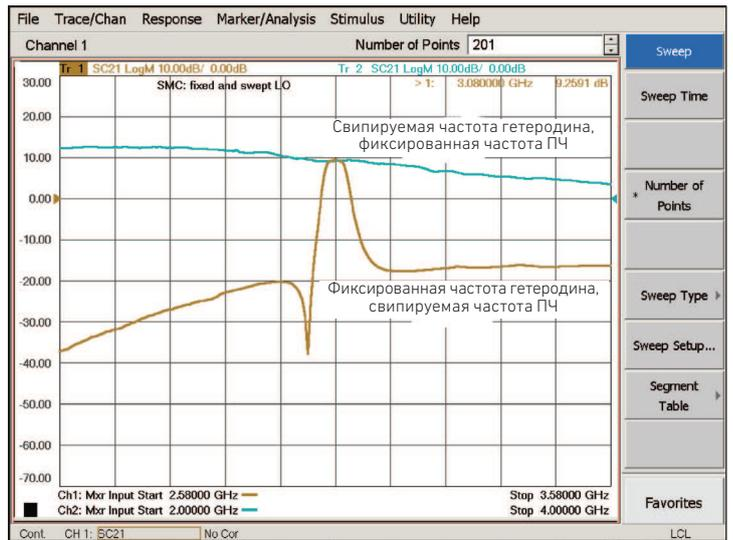
Имея два внутренних источника сигнала, PNA-X обеспечивает быстрые измерения как при фиксированной, так и свирируемой частоте ПЧ.
