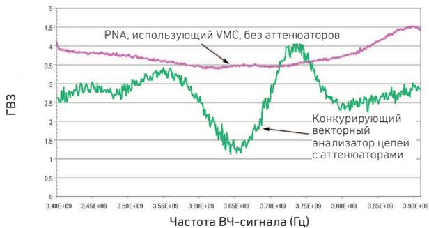
Коррекция согласования векторной калибровки смесителя (VMC) позволяет значительно уменьшить ошибки рассогласования при измерениях GBW, устраняя необходимость использования аттенюаторов на концах измерительных кабелей.
