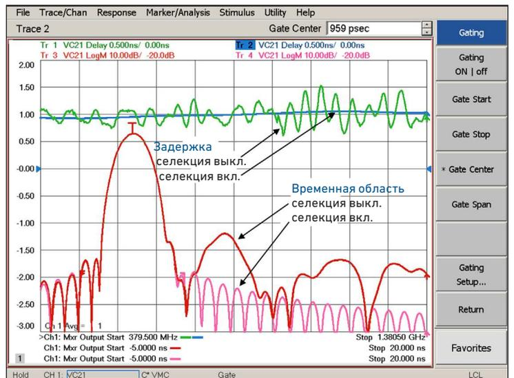
Селекция во временной области позволяет устранить неравномерность характеристики посредством удаления нежелательных, задержанных во времени, откликов из-за паразитных сигналов.
