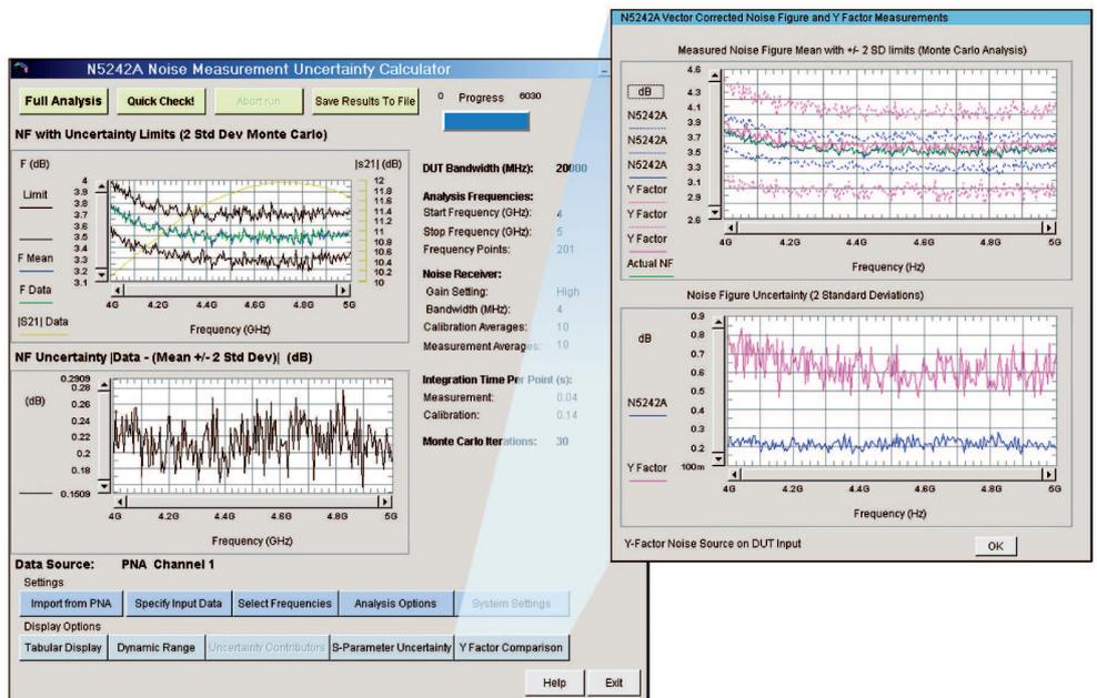
Пример погрешностей измерения коэффициента шума в автоматизированной испытательной системе (АИС). Метод коррекции неполного согласования в источнике, используемый PNA-X, обеспечивает значительно более точные результаты измерения, чем метод Y-фактора..
