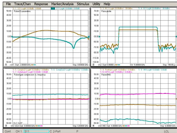
PNA-X позволяет точно определять параметры активных устройств в импульсных режимах, используя один набор подключений к ТУ. В данном примере показаны результаты измерений: S-параметров в импульсном режиме, профили импульса (входная и выходная мощность во временной области), зависимости коэффициента усиления от частоты и интермодуляционных искажений в режиме свипирования частоты.
