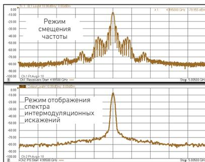
Режим смещения частоты, как правило, имеется в векторных анализаторах цепей, но у традиционных фильтров ПЧ обнаруживаются заметные боковые лепестки. Режим отображения спектра интермодуляционных искажений (IM Spectrum mode) использует оптимизированный цифровой фильтр ПЧ и обеспечивает реальную возможность измерения в режиме анализа спектра в PNA-X.
