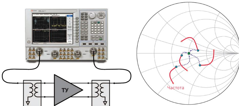
Измерение дифференциальных устройств путём исключения цепей симметрирующих устройств и противофазных делителей мощности.
