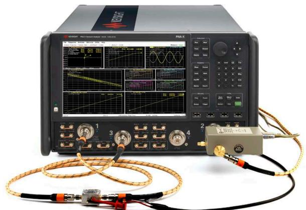
Программные приложения NVNA и принадлежности превращают 4-портный анализатор цепей PNA-X компании Keysight в высокопроизводительный анализатор для нелинейного векторного анализа цепей.
