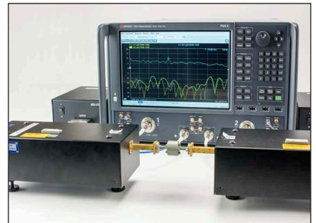
Непосредственное подключение модулей VDI к 4-портовому анализатору цепей серии PNA-X позволяет проводить измерения S-параметров до 1,5 ТГц.
