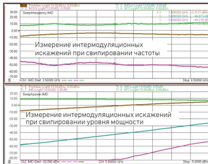
Приложение IMD измеряет продукты интермодуляционных искажений и точку пересечения третьего порядка, используя 201 точку при свипировании частоты (или уровня мощности), фактически за секунды в сравнении с несколькими минутами при использовании генераторов сигналов и анализатора спектра.
