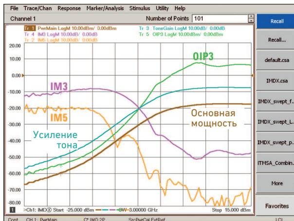
Зависимость интермодуляционных искажений и точки пересечения третьего порядка (IP3) от мощности сигнала гетеродина позволяет получить максимальное значение IP3 при наименьшей возможной мощности возбуждения гетеродина. Это помогает определить параметры установки смесителя для достижения максимальной эффективности при минимальном потреблении мощности.
