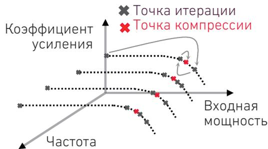
Для измерения компрессии коэффициента усиления с помощью анализатора цепей обычно используется свипирование уровня мощности на нескольких частотах НГ-сигнала. Приложение GCA анализаторов цепей PNA-X упрощает определение характеристик компрессии в пределах рабочего диапазона частот ТУ за счёт исключительно высокой скорости, точности и простоты настройки параметров измерения.
