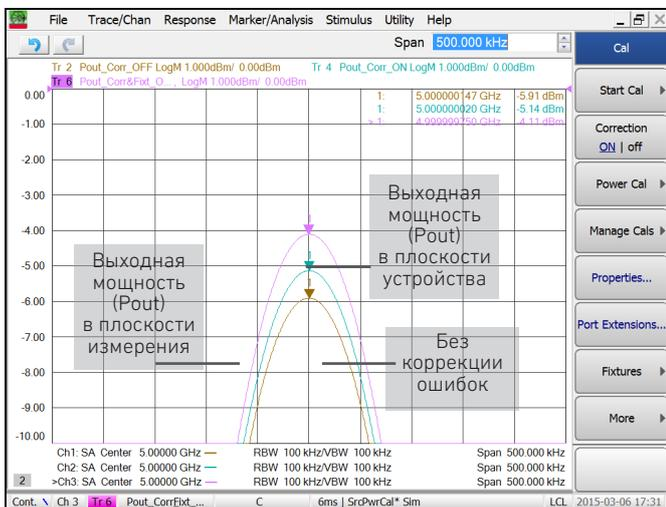
Методы калибровки и функция исключения цепей ВАЦ удаляют эффекты кабелей и тестовой оснастки и корректируют неравномерность АЧХ приёмника, обеспечивая калиброванные измерения спектра в тестовой оснастке.
