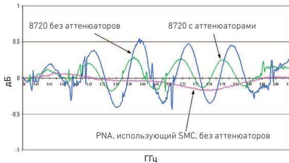
Коррекция согласования скалярной калибровки смесителя (SMC) позволяет значительно уменьшить ошибки рассогласования при измерениях потерь/усиления преобразования, исключая необходимость использования аттенюаторов на концах измерительных кабелей.
