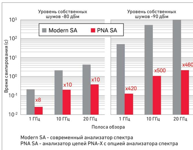
Зависимость времени свипирования от ширины полосы обзора при центральной частоте 12 ГГц для значений уровня собственных шумов -80 дБм и -90 дБм. Атенуатор приёмника устанавливается, чтобы предотвратить компрессию при использовании сигнала с уровнем +10 дБм.
