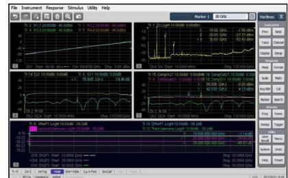
Кроме измерения S-параметров при определении характеристик усилителя с диапазоном частот от 10 МГц до 125 ГГц используются следующие приложения: анализатор спектра, измерение компрессии в панорамном режиме и измерение параметров дифференциальных и I/Q-устройств.
