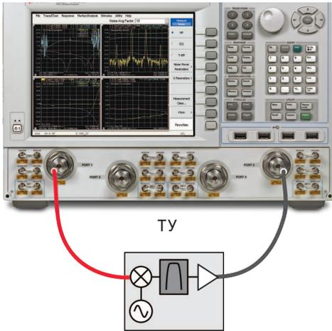
Для измерения преобразователей частоты со встроенными гетеродинами без доступа к внутренним временным базам можно использовать как метод скалярной калибровки смесителей (SMC), так и метод векторной калибровки смесителей (VMC).
