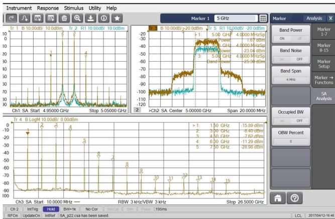
Опция анализатора спектра добавляет к PNA-X возможность быстрого поиска паразитных сигналов, заменяя в испытательных системах, предназначенных для определения параметров компонентов, отдельно приобретаемые анализатор спектра и матричный коммутатор.
