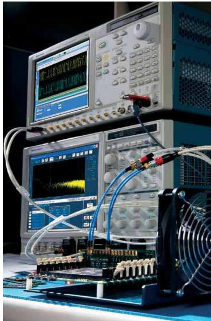
Рис. 1. Для большинства измерений требуется решение, состоящее из генератора сигналов и регистрирующего прибора. Цепь запуска облегчает захват выходного сигнала исследуемого устройства.
