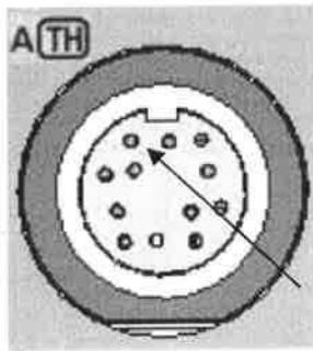
Рисунок 3 – Подключение мультиметра к разъему блока
