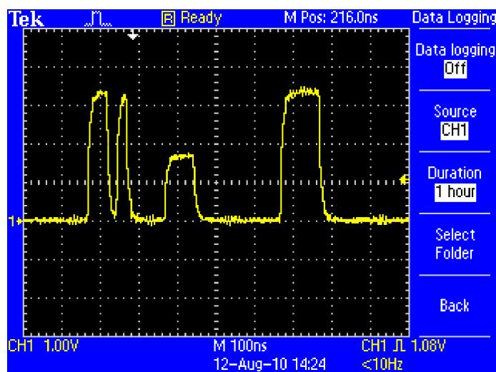
Функция регистрации данных позволяет автоматически сохранять захваченные сигналы.
