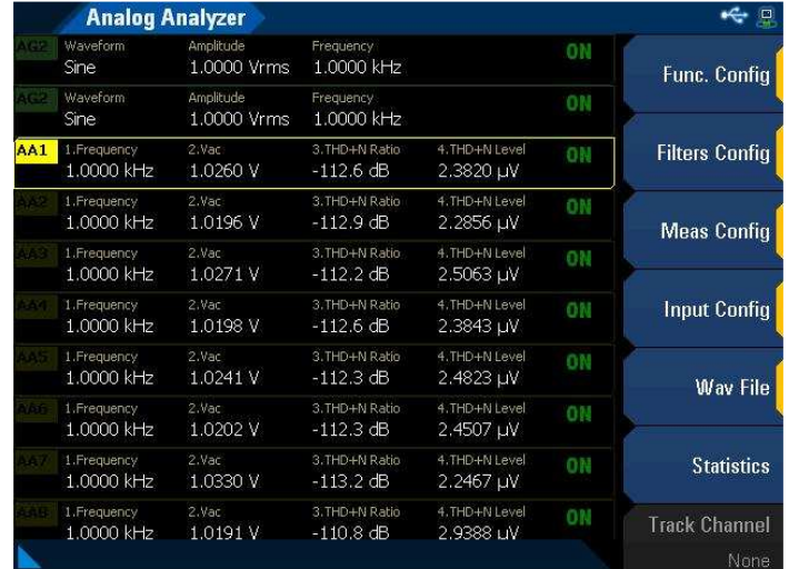
Рисунок 4. Измерение по 8 каналам анализатора в ГИП U8903B
