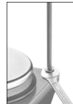
Hinweis: Beim Verwenden von Badbefestigungsteilen mit einem Durchmesser von über 180 mm ist eine Stützstange mit einer Verlängerung zu verwenden (siehe „**Zubehör**“).
