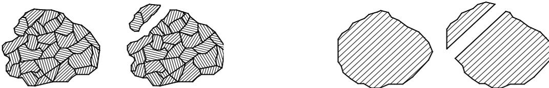
Рис. 5.29 Поликристаллические алмазы (справа) и монокристаллические алмазы (слева)
