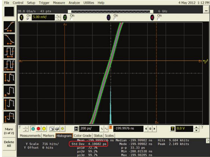
Рис. 3. Измерение джиттера сигнала, созданного по Trueform
