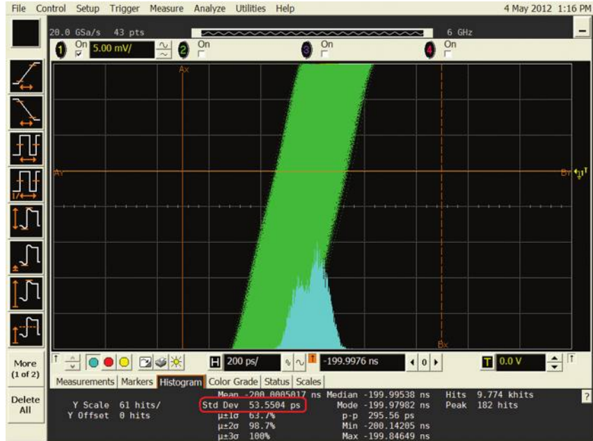
Рис. 4. Измерение джиттера сигнала, созданного по DDS
