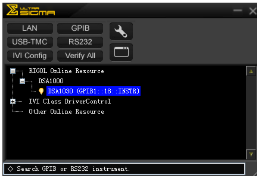
Рисунок 4-9Просмотр подключенного через GPIB измерительного оборудования
