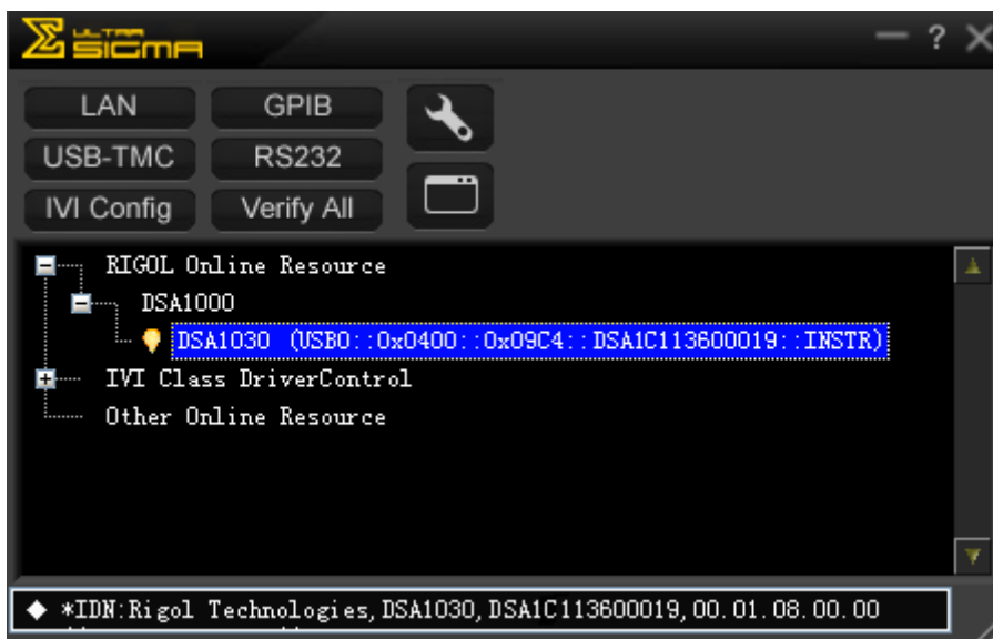
Рисунок 4-2 Просмотр подключенного через USB разъем измерительного оборудования
