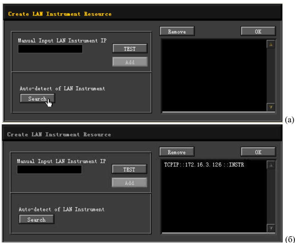
Рисунок 4-4 Поиск сетевого источника оборудования
