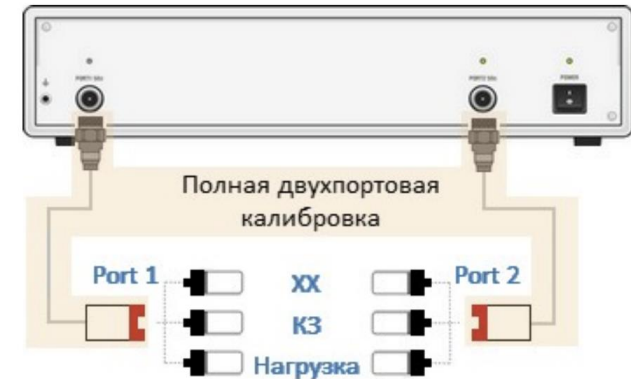
Рисунок – Первый этап калибровки с неизвестной перемычкой SOLR
