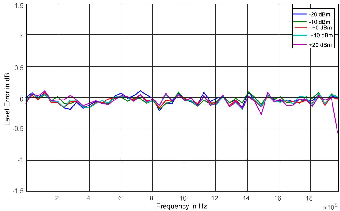
**Линейность мощность (RFSU20) тип.**
