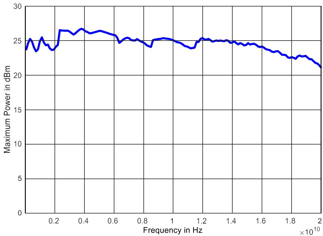
**Максимальная выходная мощность RFSU40 тип.**
