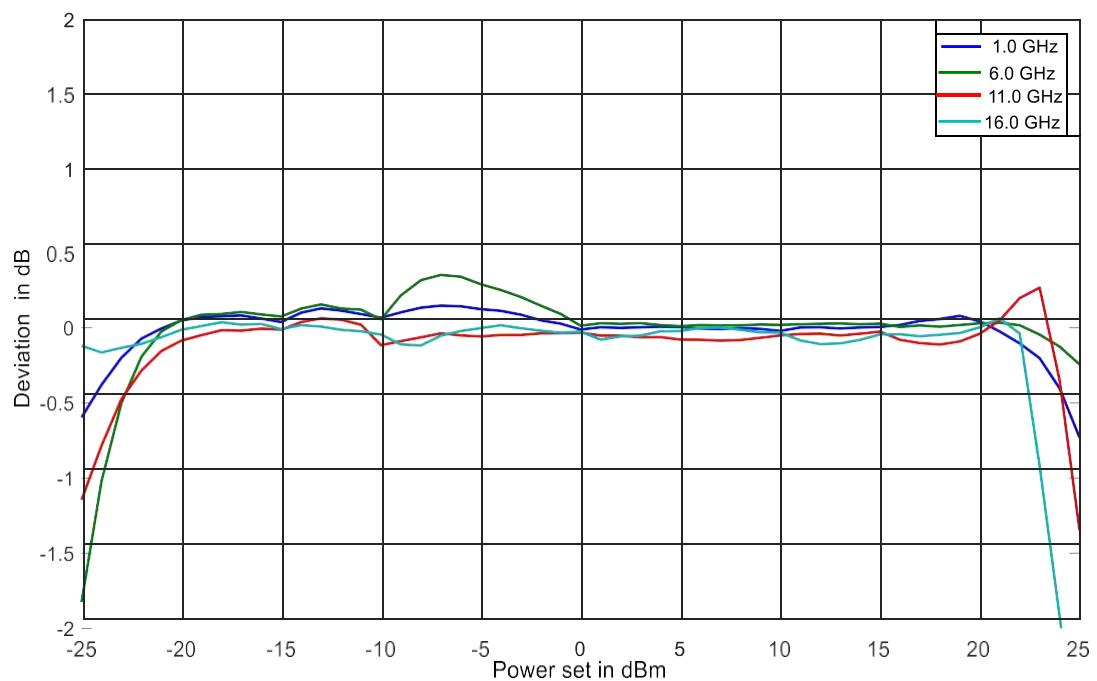
**Максимальная выходная мощность RFSU20 тип.**
