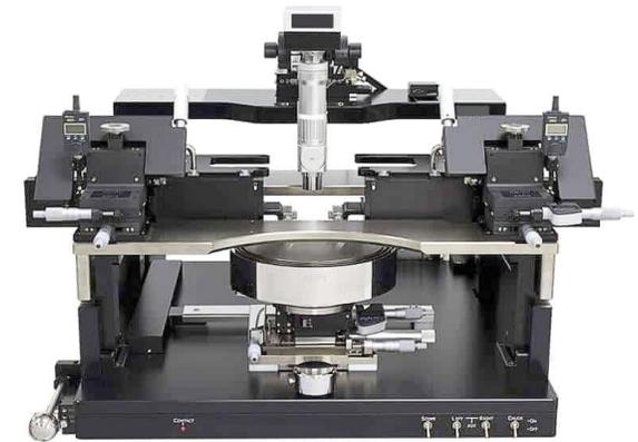
Зондовая станция для проведения ВЧ и СВЧ-измерений на пластине
