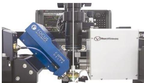
Измерения ВЧ-параметров устройств в диапазоне до 1,5 ТГц, Load-Pull измерения
