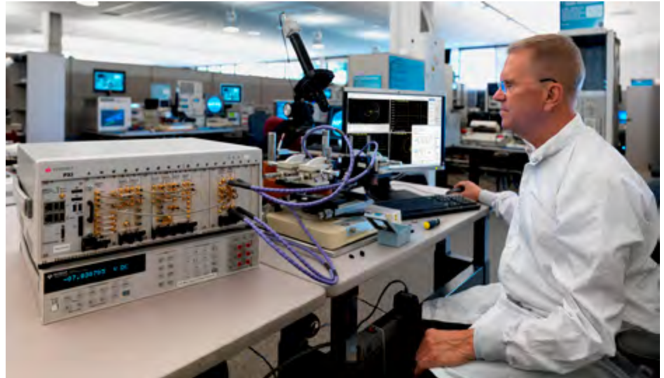
Тестирование усилителя мощности при помощи векторного анализатора цепей M937xA в формате PXIe, векторного генератора сигналов M9381A в формате PXIe и векторного анализатора сигналов M9391A в формате PXIe, а также измерительных программных приложений
