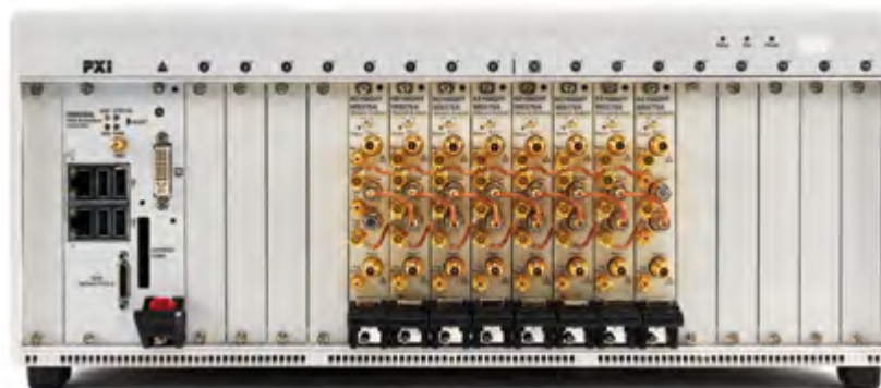
Рис. 2. В данной универсальной многопортовой конфигурации в одном шасси используются восемь 2-портовых векторных анализаторов цепей в формате PXI
