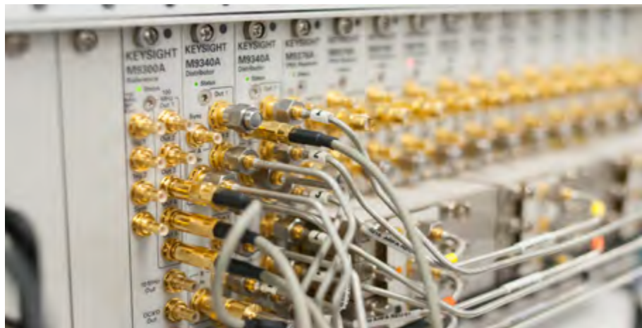
Рис. 3. M9485A - новый многопортовый векторный анализатор цепей
