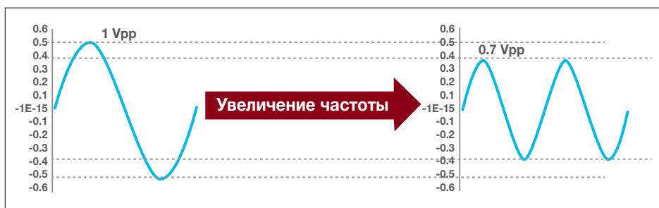
Рис. 4. Пример, показывающий достижение точки 3 дБ по мере увеличения частоты.
