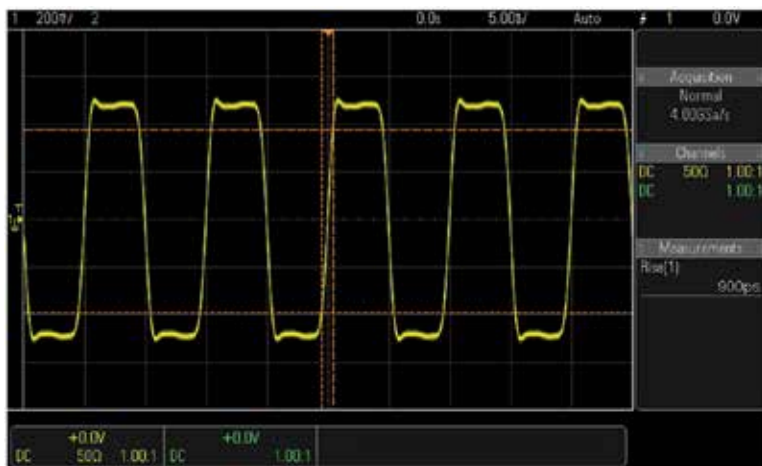
Рис.7. Тактовый сигнал 100 МГц, полученный пробником с полосой пропускания 500 МГц.
