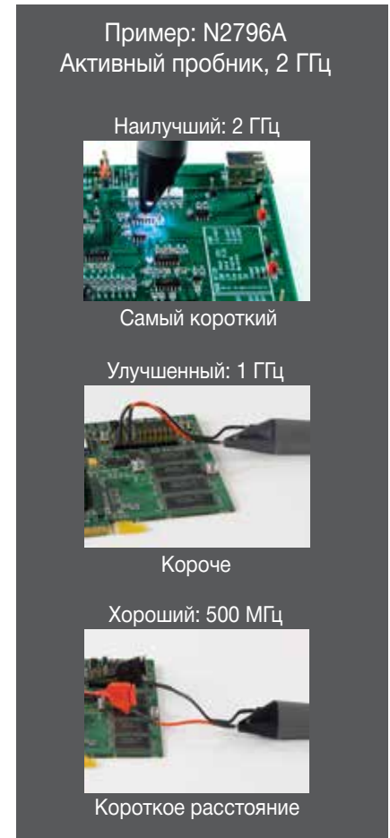
Рис. 12. Влияние различных средств подключений на полосу пропускания.
