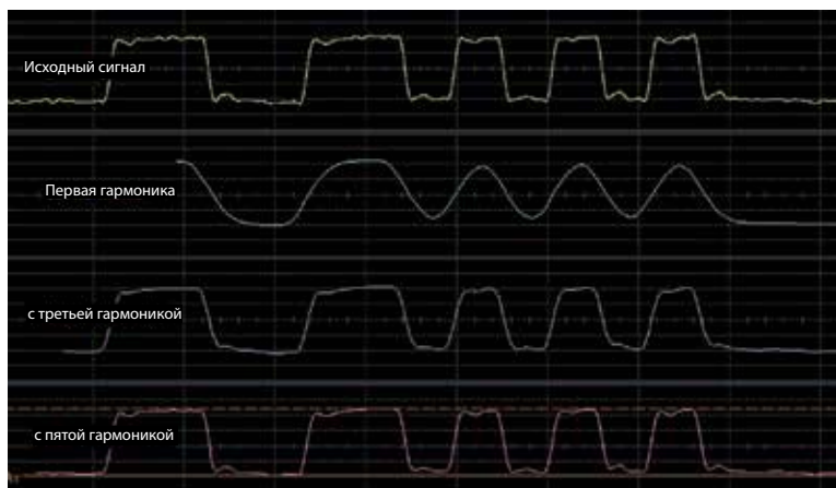
Рис.5. Более широкая полоса пропускания означает больше гармоник и более высокую детализацию сигнала.
