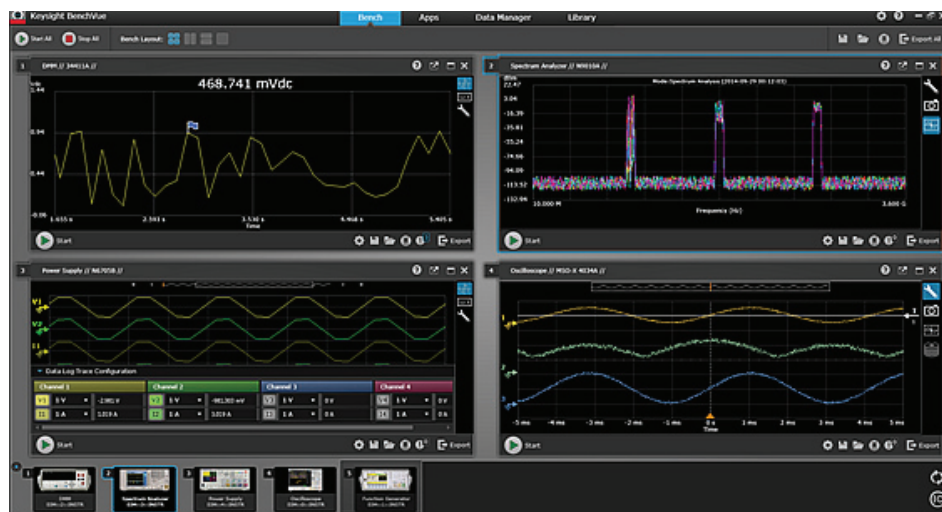
Рис. 4. Интерфейс программы BenchVue, соединенной с четырьмя приборами
