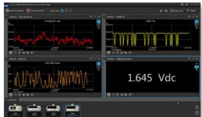
Рисунок 6. Приложение, исполняемое на ПК, может одновременно отображать результаты измерений четырёх поколений цифровых мультиметров, используя режим рабочего стола с несколькими окнами.
