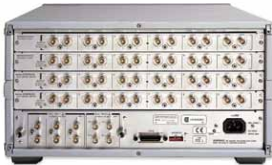
Коммутатор с малыми токами утечек Keysight E5250A (вид сзади)
