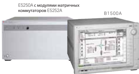
Решение для измерения ВФХ-ВАХ по 2-проводной схеме
