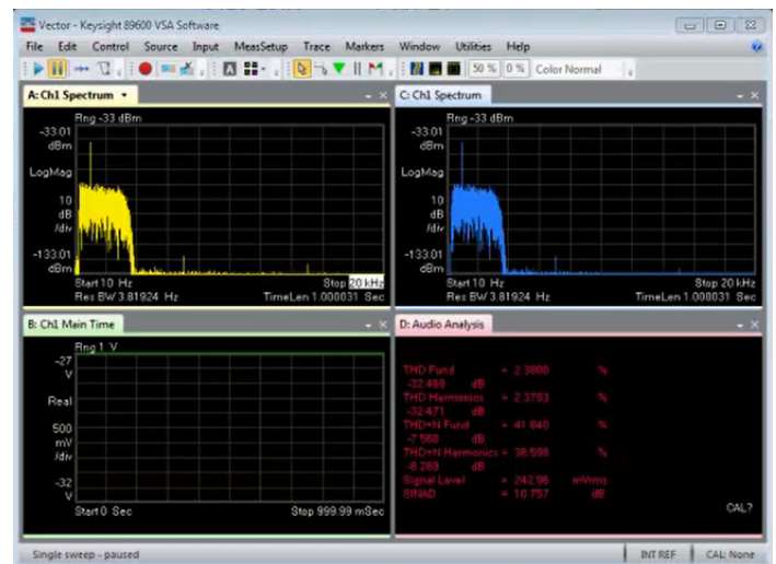
Измерение параметров аудиосигнала (SINAD, THD) при помощи ПО 89600
