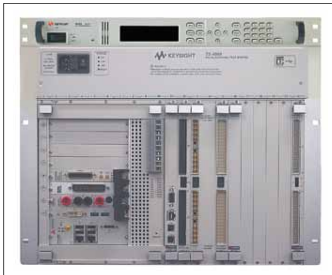
Рис. 3. В эту конфигурацию системы функционального тестирования Keysight TS-8989 PXI входит программируемый источник питания (сверху), 8-слотовое шасси PXI (слева внизу) и 11-слотовый блок коммутации/нагрузки (справа внизу)
