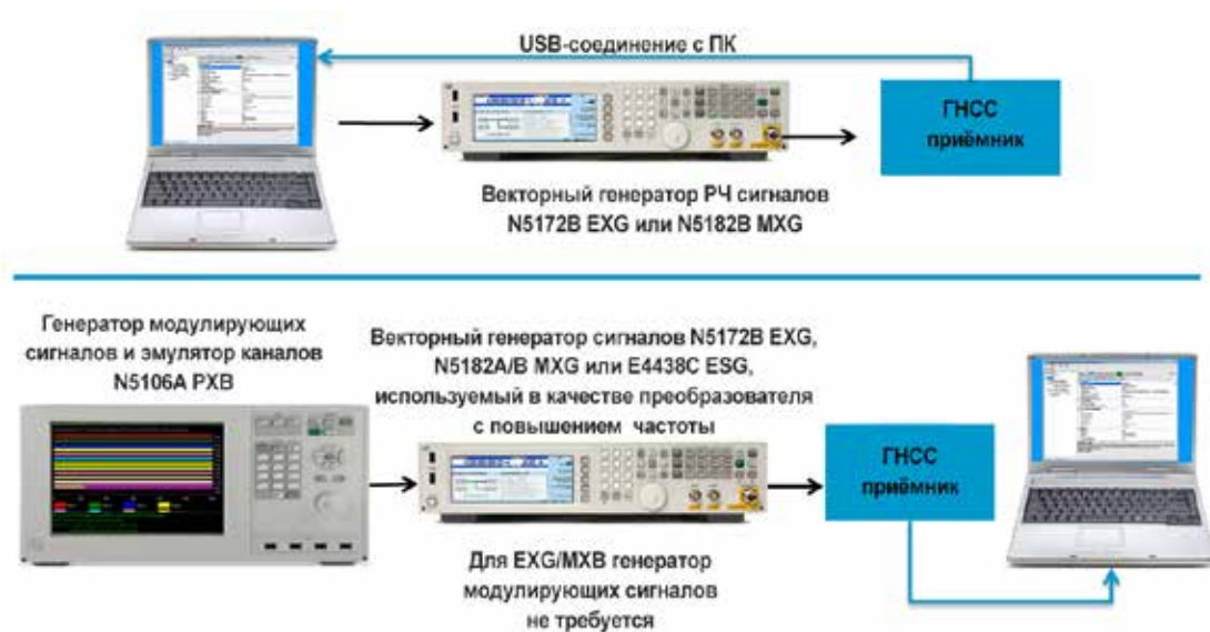
Рис. 15. Использование ПО N7609B Signal Studio для тестирования приемников ГНСС.
