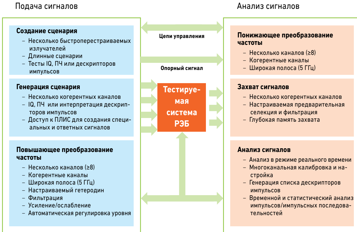
Рис. 2. Благодаря функциям генерации и анализа сигналов, эта система пригодна для разработки и проверки разных типов приёмников и постановщиков помех РЭБ.
