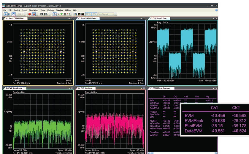
Рисунок 7 — Данные графики, полученные с помощью программного обеспечения 89600 VSA показывают результаты демодуляции РЧ-сигналов системы MIMO на частоте 5,8 ГГц: две диаграммы созвездий, два частотных спектра и два результата измерения EVM.
