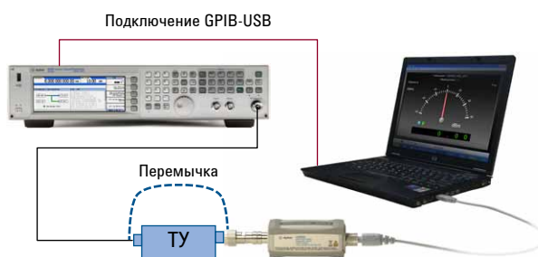
Рис. 5. Измерение параметров передачи после компенсации.
