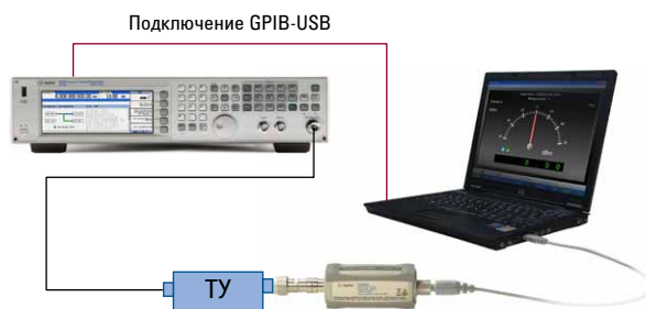
Рис. 3. Измерение параметров передачи без компенсации.
