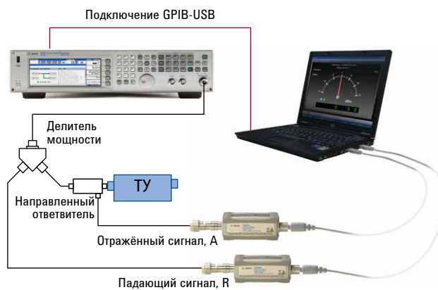
г. Измерение обратных потерь
