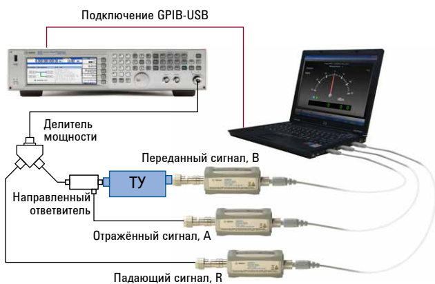
д. Измерение усиления и затухания при передаче и обратных потерь
