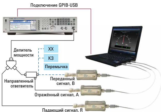
Рис. 21. Установка для калибровки перед проведением одновременного измерения усиления и обратных потерь.
