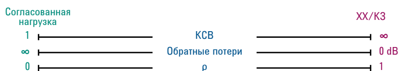
Рис. 11. Соотношения между согласованной нагрузкой и КЗ/ХХ при измерении параметров отражения.
