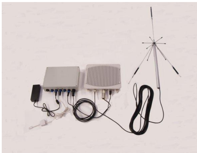
Рис. 2. Типовая система с РЧ сенсором и контроллером AMS
