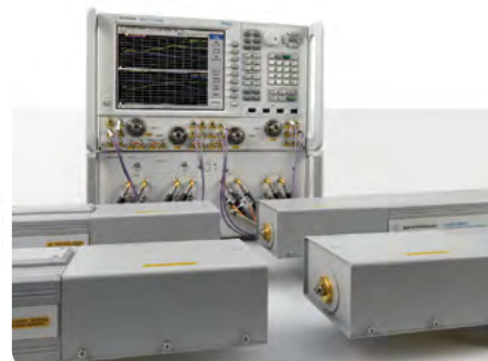
Системы на базе PNA-X с диапазоном частот до 110 ГГц поставляются в 2- или 4-портовых версиях. Они обеспечивают управление уровнем мощности, истинные дифференциальные сигналы стимулов и возможность измерения преобразователей частоты со скалярной калибровкой смесителя (SMC). Эти настольные системы являются заменой стоечных систем 8510XF, обладая при этом более высокими характеристиками.
