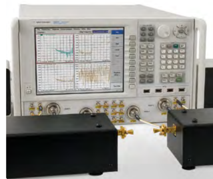
Непосредственное подключение модулей VDI к PNA-X с диапазоном частот до 50 ГГц обеспечивает измерение S-параметров до 1,05 ТГц.
