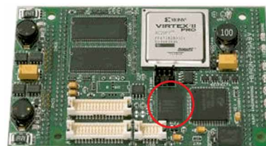
Рисунок 3 - Ограниченная площадь монтажа встроенных плат и компьютерных систем означает, что для обеспечения большего объёма памяти потребуется большее количество микросхем памяти (DRAM) скомпоновать в конфигурации модуля DIMM.
