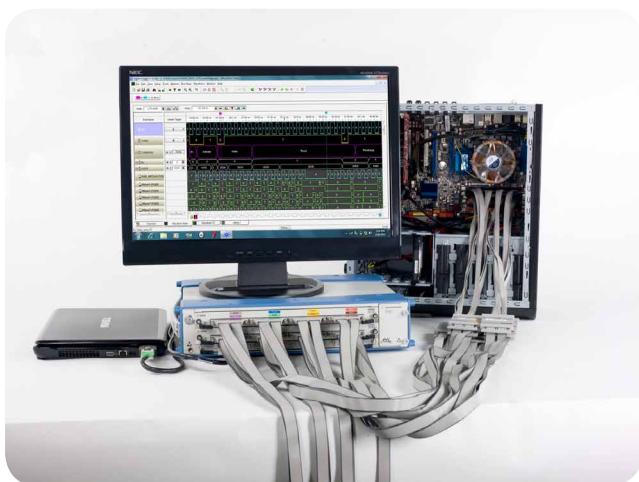
Рисунок 6 - Техническое решение на базе логического анализатора U4154A, обеспечивающее сбор данных сигналов шины DDR со скоростью до 4 Гбит/с (в режиме двойной выборки - по обоим перепадам тактового сигнала).
