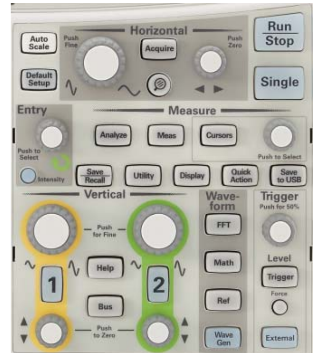
Рис. 2. На передней панели осциллографа должны быть ручки и кнопки для настройки всех основных переменных.
