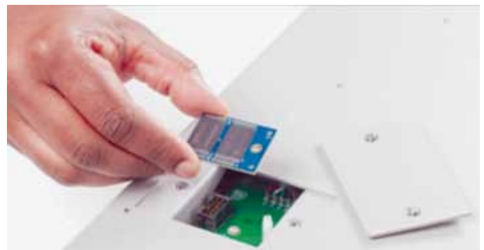
Рисунок 8. Установка «черного ящика» N7908A BBR в источник питания APS
