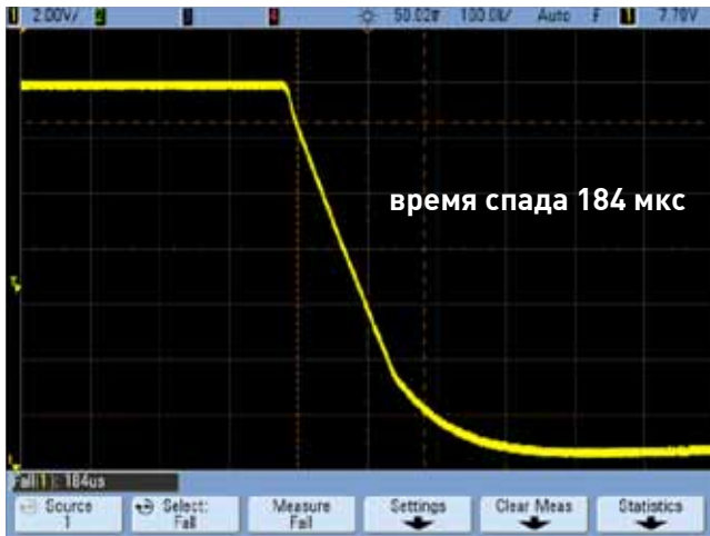
Рисунок 5. Измеренное время спада импульса прерывания составило < 200 мкс
