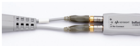
N2880A Подключаемый аттенюатор InfiniiMax модели N2880A (не включая усилитель и головку пробника)
