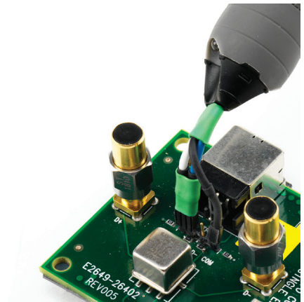
Пробник N2750A с наконечником N4822A, оснащенным гнездами разъемов для подключения к тестируемому устройству
