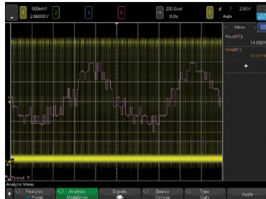
Рис. 5. График вариаций длительности и интервалов между импульсами сигнала ШИМ за достаточно длительный период времени позволяет получить характеристики контура управления в системе обратной связи.
