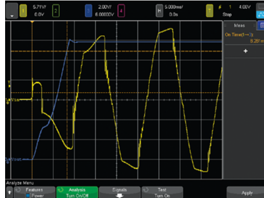
Рис. 7. Анализ времени включения позволяет определить время стабилизации напряжения на выходе источника питания после подачи входного напряжения.
