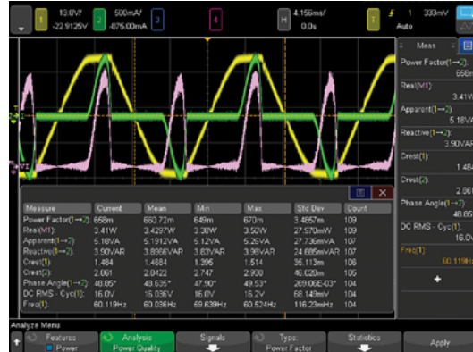
Рис. 4. Результаты измерения мощности отображаются в виде таблицы со следующими параметрами качества электроснабжения: коэффициент мощности, активная мощность, полная мощность, реактивная мощность, пик-фактор и фазовый сдвиг.
