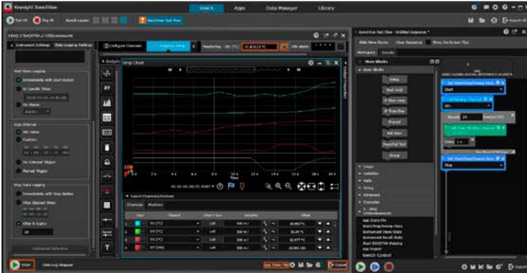
Рисунок 5. Программный модуль для систем сбора данных из состава пакета прикладного ПО BenchVue, позволяющий осуществлять регистрацию данных, мониторинг (построение графиков трендов) и запись данных в режиме реального времени.
