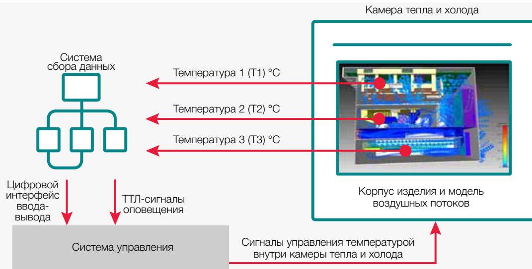
Рисунок 8. Базовый блок системы сбора данных DAQ970A оснащён цифровыми входами/выходами и способен формировать ТТЛ-сигналы оповещения пользователя.
