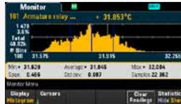
Рисунок 9. DAQ970A предоставляет статистические данные в реальном времени на основе результатов измерений.
