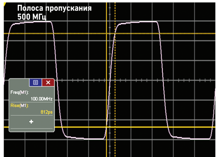
Рис. 4. Тактовая частота 100 МГц, захваченная осциллографом с полосой пропускания 500 МГц
