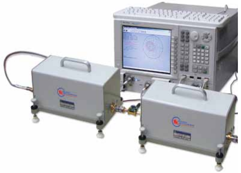
Измерения устройств с произвольным импедансом с помощью анализатора цепей серии PNA-X и тюнеров от Maury Microwave
