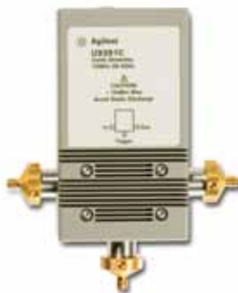
Генератор комбинационных частот U9391C диапазона 10 МГц – 26,5 ГГц
