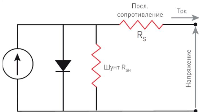
Рис. 6. Упрощенная модель солнечного элемента.
