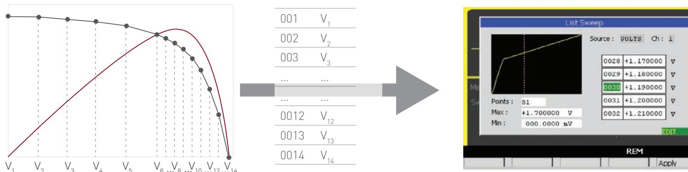
Рис. 8. Режим свипирования по списку прецизионного параметрического анализатора серии B2900A позволяет определить характеристики фотогальванических элементов в интересующей области.
