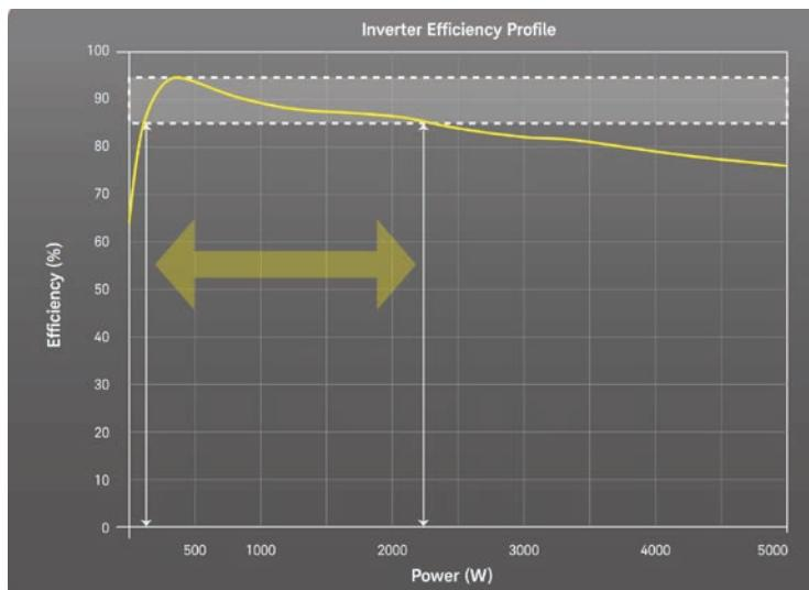
Рис. 16а. Зависимость КПД солнечного инвертора от мощности.
