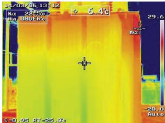
Рис. 18. ИК-изображение трансформаторов под напряжением.
