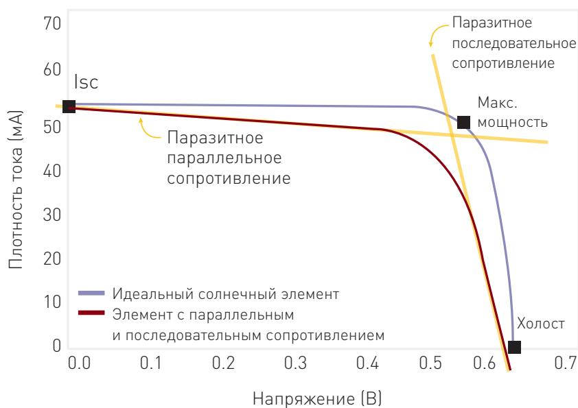
Рис. 7. Вольт-амперная характеристика солнечного элемента.
