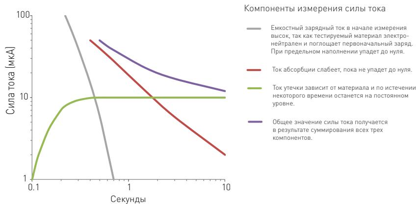
Рис. 10а. График тока утечки в изолирующем материале с течением времени.
