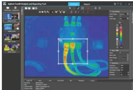
Рис. 9а. ИК-изображения кабелей и межсоединений помогают выявить признаки перегрева.
