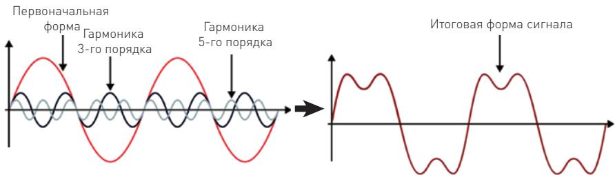
Рис. 15. На графике показана форма сигнала, получившаяся в результате наложения синусоидальной волны и гармоник третьего и пятого порядка.
