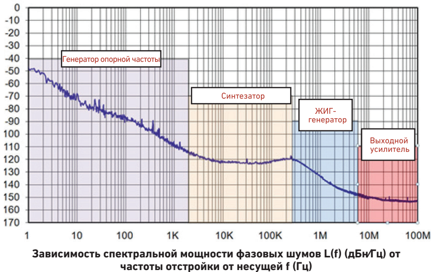
Рисунок 2 - Составляющие характеристик фазового шума генератора сигналов могут быть отслежены и сопоставлены с основными блоками его внутренней архитектуры.
