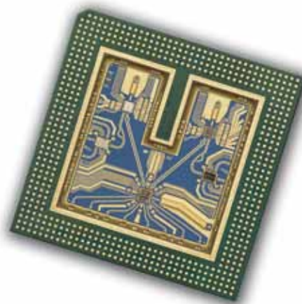
Многочиповый модуль в осциллографах семейства Infiniium обеспечивает работу в широкой полосе частот с малым уровнем шума
