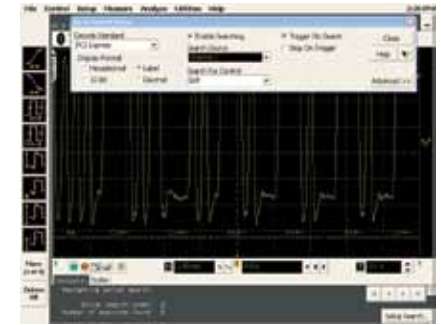
ПО контроля электрических характеристик и проверки на соответствие стандарту PCI Express® позволяет тестировать платы расширения и материнские платы на соответствие электрическим характеристикам PCIe 1.1 и PCIe 2.0.
