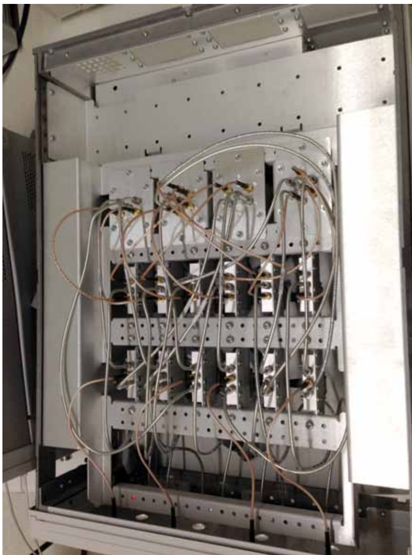
Рис. Полный матричный коммутатор 2×10
