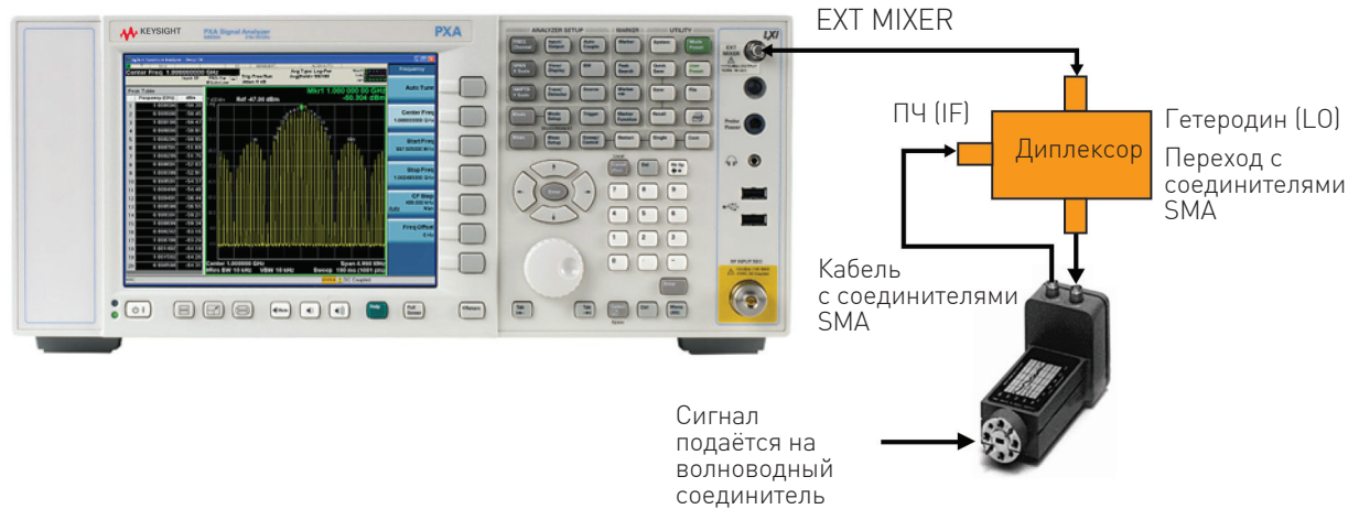
Рисунок 1. Средства подключения устаревших смесителей серии 11970 включают диплексор и дополнительные компоненты для сопряжения с анализатором сигналов PXA.
